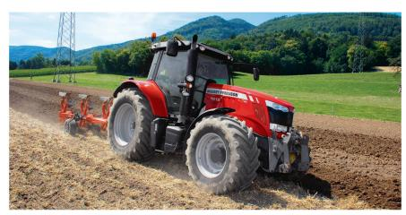
On peut économiser 10 à 20% de diesel en réglant correctement la charrue et en réduiant la pression des pneus lors des travaux dans les champs.
