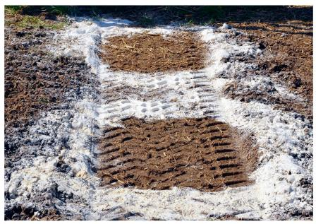
La réduction de la pression des pneus augmente la surface de contact avec le sol. Photo: Ruedi Hunger
