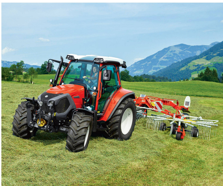
Le régime de la prise de force doit permettre au tracteur de fonctionner dans la plage d'économie de carburant. Photo: Lindner
