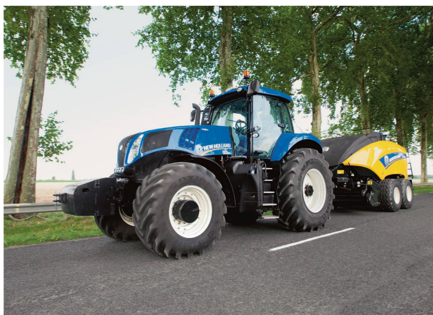
La consommation de diesel peut augmenter de 120% si l'on garde la pression de terrain (0,5 bar) sur la route au lieu de privilégier celle qui convient sur la route (1,6 bar). Photo: CNH
