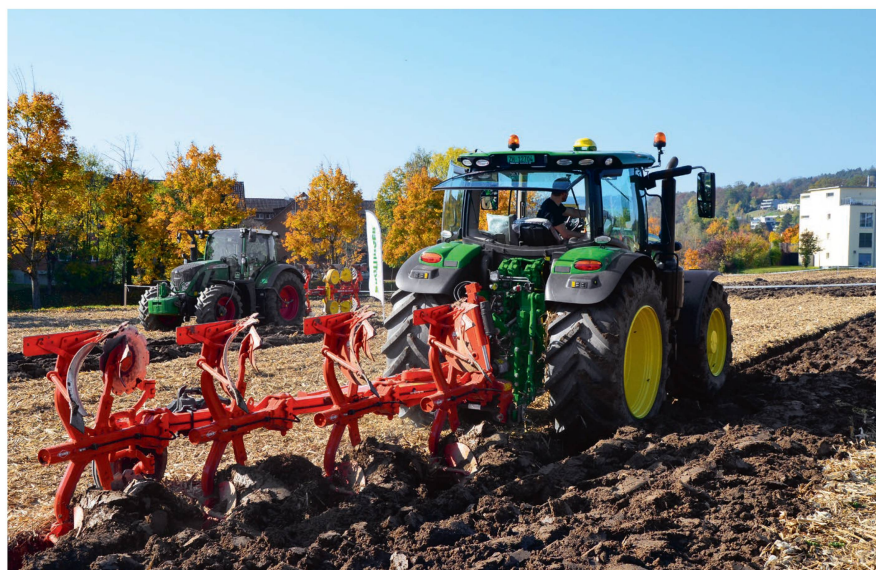
Le labour exige beaucoup de puissance de traction, car chaque centimètre de profondeur déplace 150 t/ha par hectare. Photo: Ruedi Hunger
