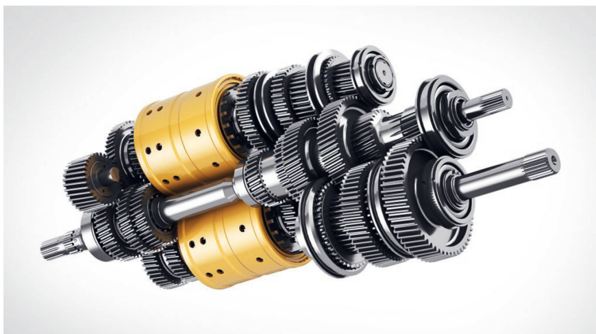
Boîte à 8 rapports enclenchables sous charge avec double embrayage CNH: deux embrayages multidisques suffisent à passer les huit vitesses sans rupture de couple. Photo: CNH
