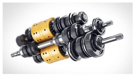
Boîte à 8 rapports enclenchables sous charge avec double embrayage CNH: deux embrayages multidisques suffisent à passer les huit vitesses sans rupture de couple. Photo: CNH
