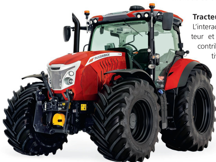
Le McCormick «X7.618» est un des nouveaux tracteurs à moteur 6-cylindres à empattement court. La suspension de la cabine est, au choix, mécanique ou semi-active hydropneumatique. A l'inverse des plus grands modèles «X7.6», ce tracteur n'a pas de demi-châssis en fonte. Photo: McCormick
