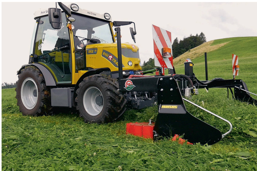
Le Rigitrac «SKE40 Electric»: avec ses quatre moteurs électriques, il tire le meilleur parti possible de l'électrification. Photo: Roman Engeler
