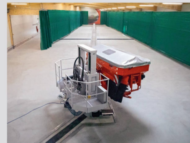
Aperçu du centre d'essais le plus moderne d'Europe; l'épandeur est ici monté sur un plateau tournant.
