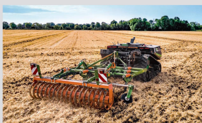
Le tracteur «AgBot» de 156 chevaux tracte un cultivateur à 3 rangées d'outils de type «Cenio» dans un champ de chaumes.
