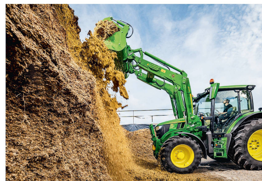
Les chargeurs frontaux peuvent recevoir la pesée dynamique, opérante y compris en mouvement.
