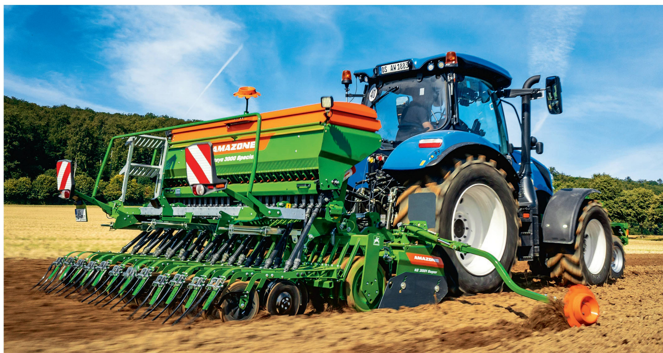
Le semoir «Cataya Special» peut désormais recevoir en option des socs à doubles disques de type «TwinTec». Photos: Amazone
