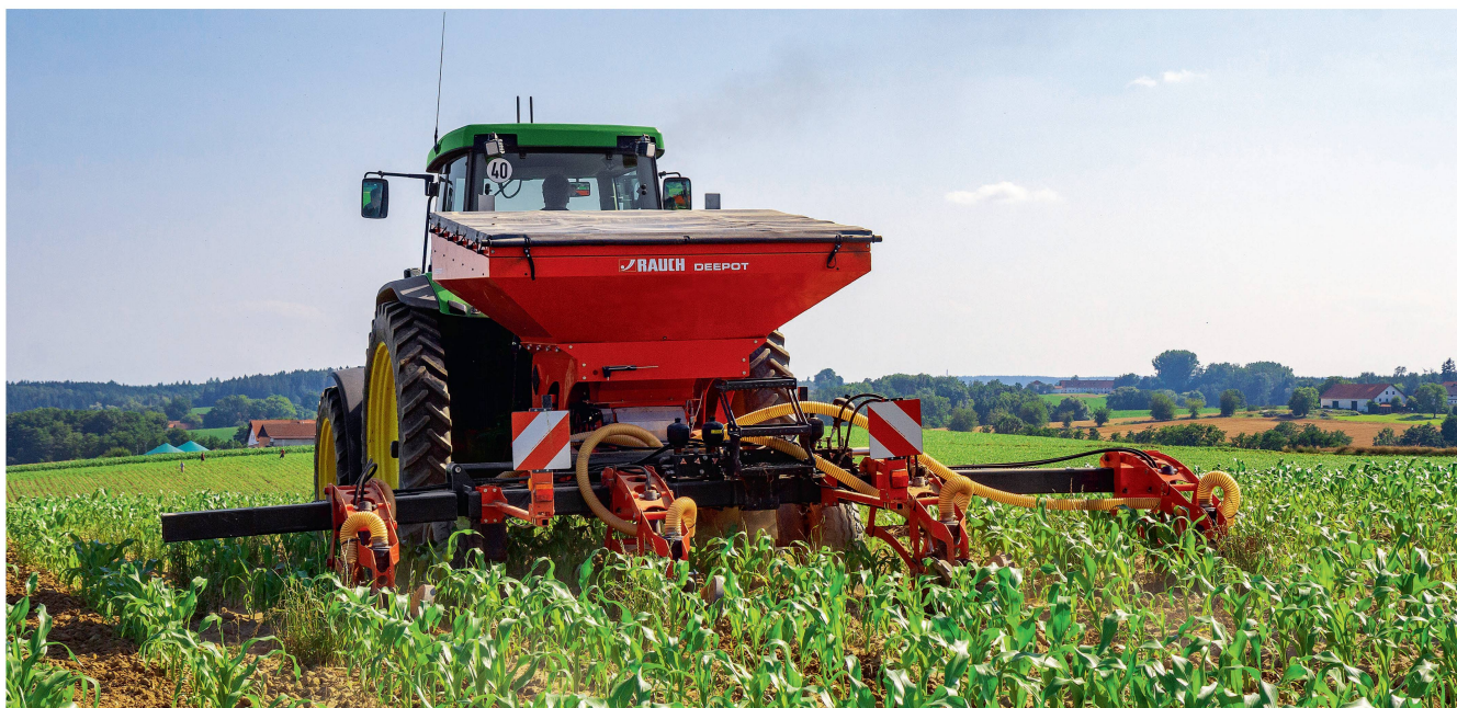
Le nouveau concept de fertilisation en profondeur «DeePot» de l'entreprise Rauch comporte une trémie arrière et quatre socs injecteurs montés sur une barre.. Photos: Rauch
