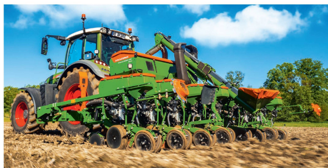
Pour une levée homogène des semis, Amazone propose son système «SmartForce» qui ajuste automatiquement la pression des socs de semis de son semoir monograine «Precea». Les éléments semeurs et de dépose de l'engrais, peuvent se déporter latéralement de 40 cm au maximum pour créer des traces de passage de roues.
