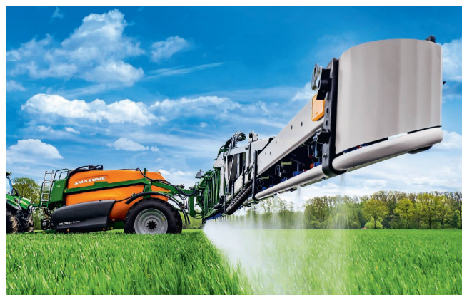
Le pulvérisateur «UX 7601 Super» possède un châssis d'une seule pièce incluant le timon. Son centre de gravité est proche du sol.
