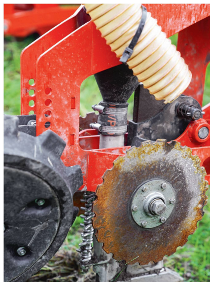
Un soc injecteur avec (de gauche à droite) les roues de rappui, les ressorts racleurs (brevet en instance), le tube de descente avec le «cyclone» au-dessus et la «torpille» (le disque ouvreuse se trouvant en tête du dispositif est masqué par le déflecteur rouillé).
