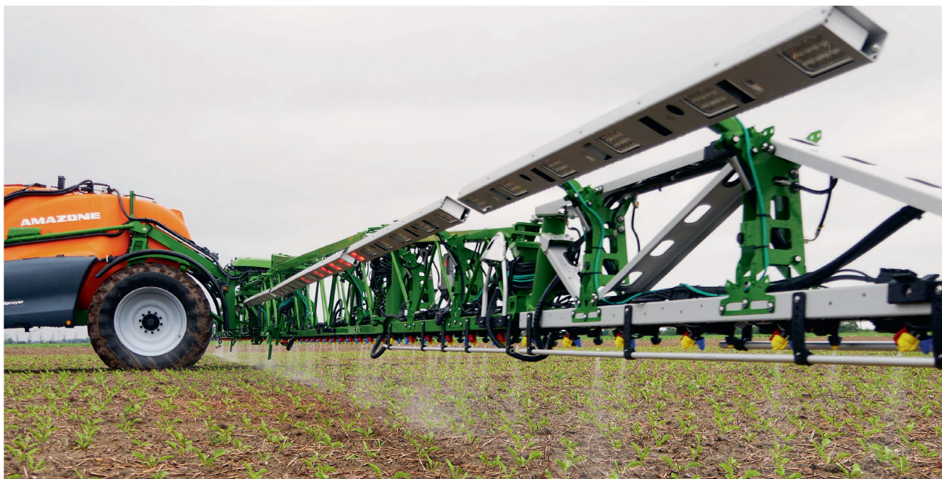
La technologie de pulvérisation ciblée «Smart Spraying» de Bosch et BASF est aujourd'hui en mesure de désherber sur parcelle non levée (green on brown) ou d'appliquer un traitement localisé sur culture (green on green). Photo: Matthieu Schubnel
