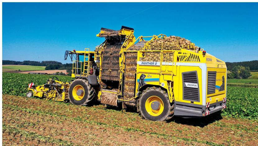
La nouvelle Ropa «Panther 2S» associe un design sportif et moderne avec une maniabilité et une agilité garantes d'une récolte de betteraves efficace. Cette machine est mue par un Volvo Penta en ligne de 16,12 litres développant 796 chevaux et un couple maximal de 3650 Nm. La conception de la machine intègre le système de train roulant médaillé, sachant ménager le sol, avec stabilisateur et compensation automatique de dévers.
