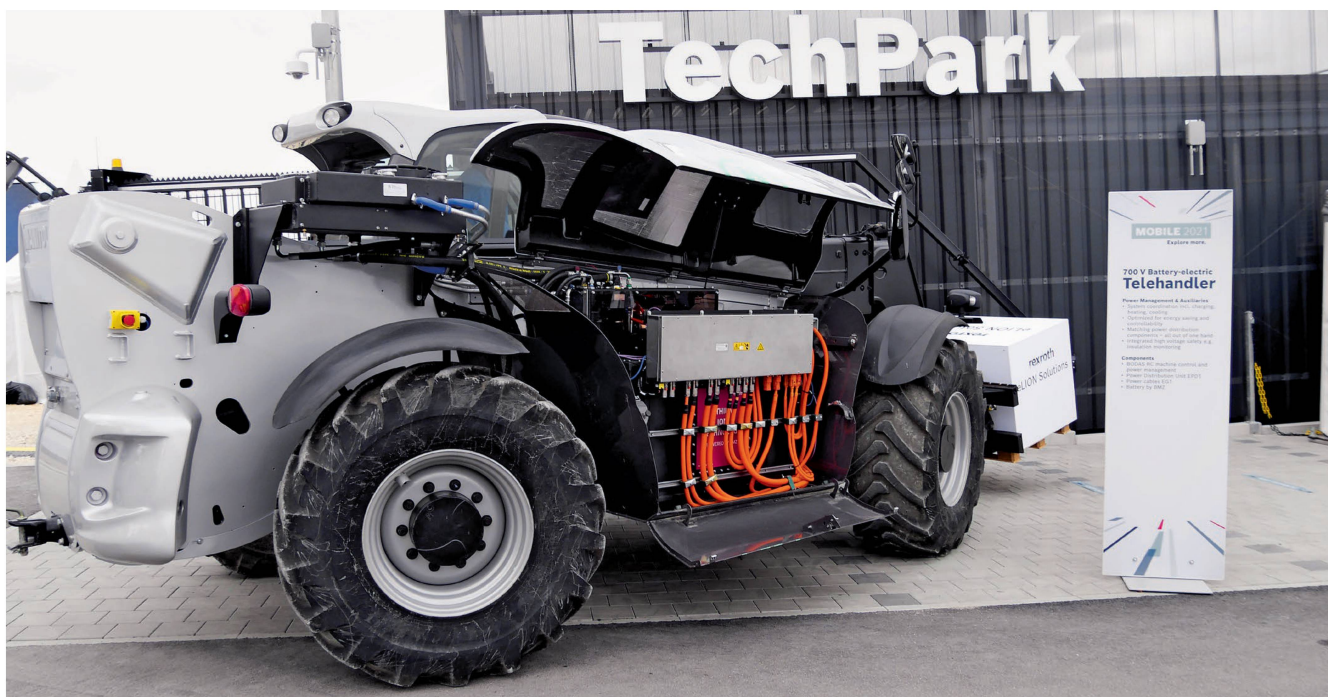
Rexroth proposera dès 2022 des solutions d'électrification complètes pour différents équipements de travail. Ce chariot télescopique de 11 tonnes est équipé de moteurs et d'autres composants électriques de la nouvelle gamme «eLION» de Bosch Rexroth. Photos: Heinz Röthlisberger
