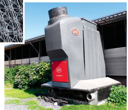
Le dispositif «N-Capture» comporte un catalyseur/filtre où l'air enrichi en ammoniac est en contact avec des acides. Cela provoque la formation de solutions de nitrate d'ammonium et de sulfate d'ammonium.
