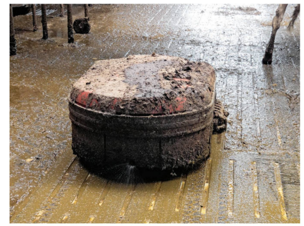
Les excréments collectés par le robot «Discovery Collector» sont déposés dans un réservoir séparé.
