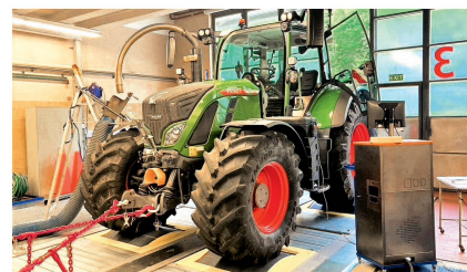
La force de retenue et la résistance au roulement ont également été mesurées en entraînant le tracteur par les roues, à l'aide d'un banc d'essais à rouleaux. Photo: J. Pochon
