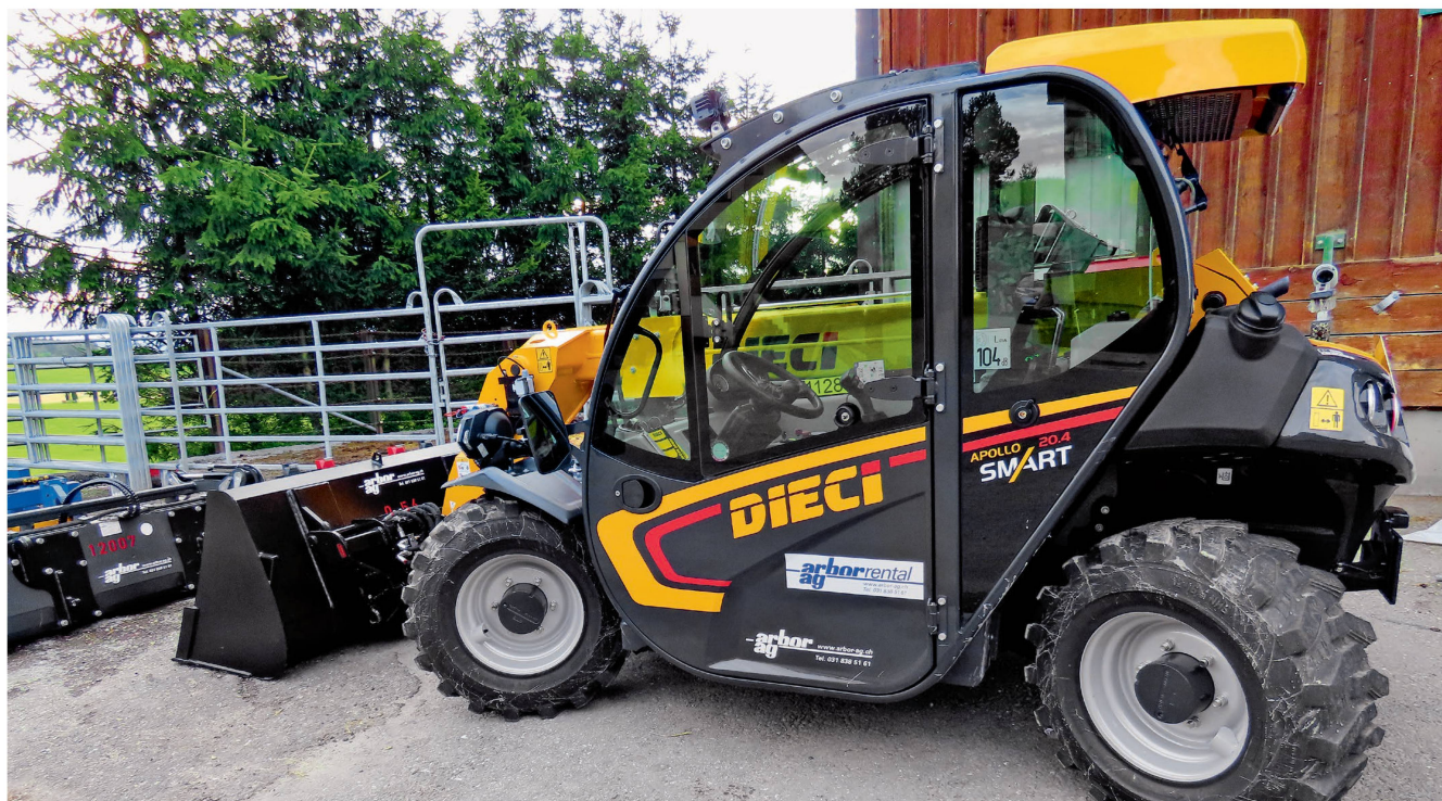
Adapté pour le chargement de vrac et pour les travaux quotidiens de la ferme, le Dieci «Mini Agri 20.4 Smart» travaille avec une grande manœuvrabilité jusqu'à une hauteur de 435 cm. Photos: Martin Abderhalden
