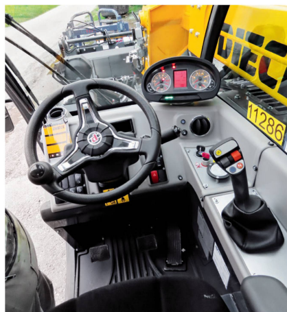
La visibilité sur la droite est limitée par le bras de levage. La cabine est toutefois confortable et offre une bonne visibilité.
