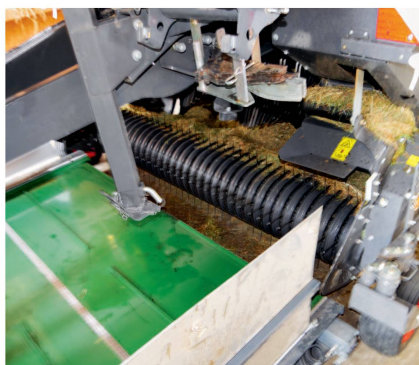
Le fourrage démêlé tombe sur un tapis en PVC muni de tasseaux et alimentant le pick-up de la presse de façon régulière, afin de réduire le risque de bourrage.
