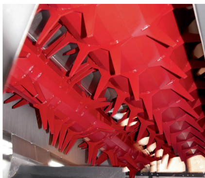
Entraînés hydrauliquement, les deux rouleaux doseurs de diamètre et de régime de rotation différenciés démêlent les paquets de fourrage en vrac déstocké.
