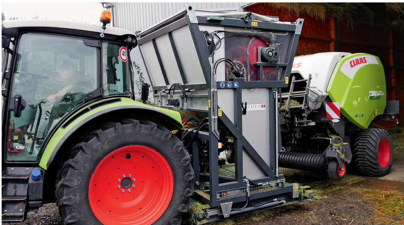
Le doseur à foin «Hayxit 19» de l'agro-entrepreneur Monney Frères Sàrl de Villariaz (FR), acquis en 2020, est attelé à un tracteur Claas Arion 460 et couplé à une presse Rollant 540 RC. Photos: Matthieu Schubnel
