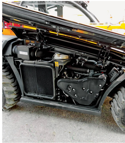
Le moteur Kubota est installé en travers du châssis. Le capot latéral assure un bon accès aux points d'entretien.
