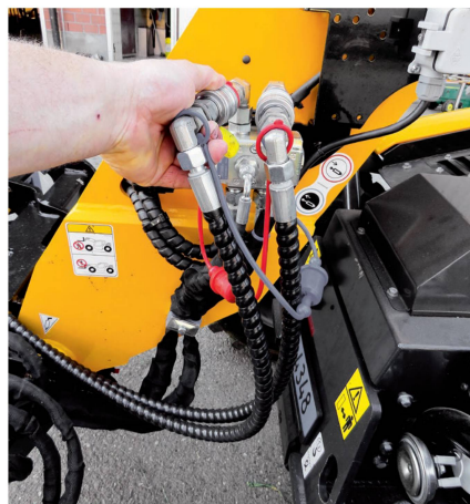
Deux distributeurs hydrauliques (quatre en option) et une prise électrique sont installés sur le bras.
