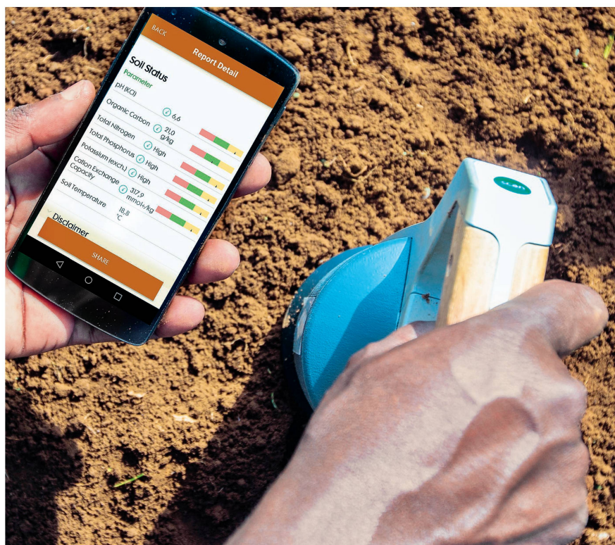
Quelques secondes après les mesures prises en pressant un bouton, les paramètres du sol sont affichés, par exemple sur l'écran d'un smartphone. Photo: Stenon GmbH
