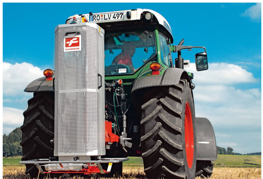
Le carottage mécanique facilite le travail et augmente la précision des échantillons de sol.
