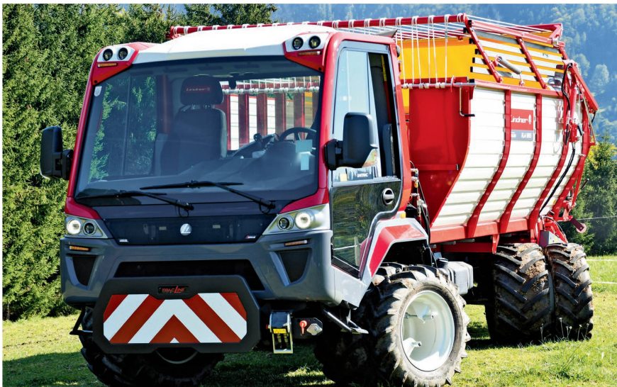
Équipé ici de la nouvelle autochargeuse Gruber, l'«Unitrac 122 LDrive» est doté d'une direction sur les quatre roues et fait ainsi preuve d'une agilité extrême. Photo: Ruedi Hunger
