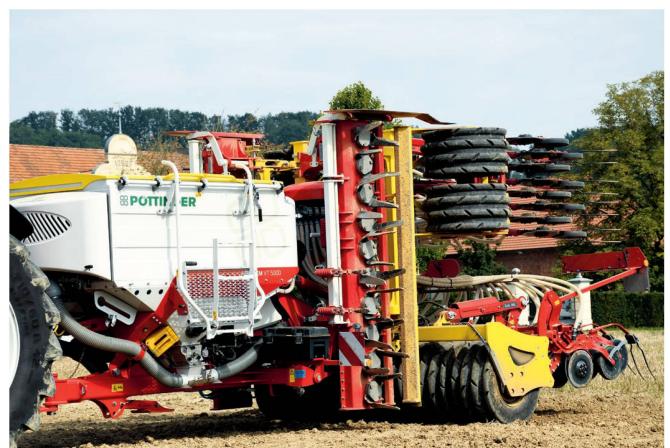
On évite les lourdes charges sur les essieux en associant l'«Aerosem VT» à une herse rotative escamotable «Lion 103 C». Photo: Ruedi Hunger
