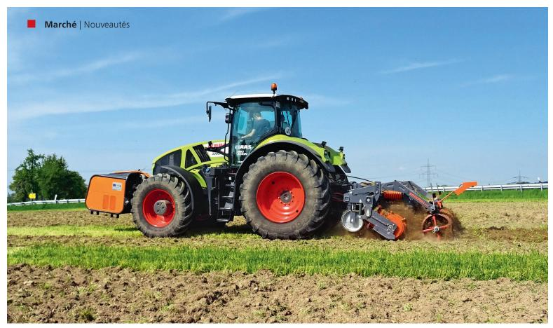
Le «Rotapull» en action, avec la génératrice à l'avant du tracteur et l'outil de préparation du sol à l'arrière. Photos: Dominik Senn
