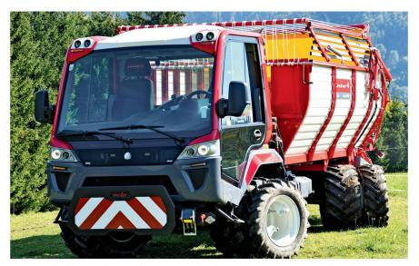
Equipé ici de la nouvelle autochargeuse Gruber, l'«Unitrac 122 LDrive» est doté d'une direction sur les quatre roues et fait ainsi preuve d'une agilité extrême. Photo: Ruedi Hunger
