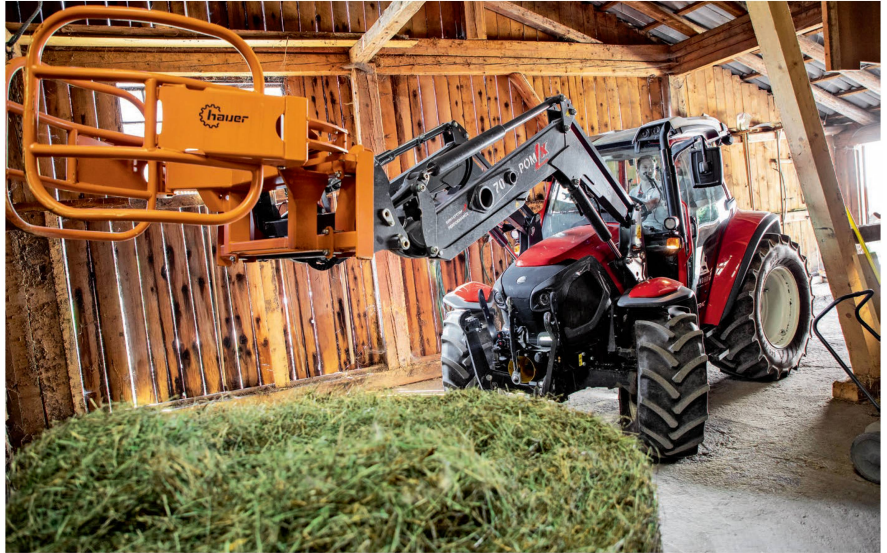
La direction sur les quatre roues confère au tracteur une plus grande liberté de mouvement à l'intérieur d'un bâtiment étroit. Photo: Lindner
