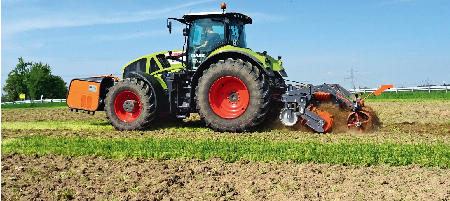
Le «Rotapull» en action, avec la génératrice à l'avant du tracteur et l'outil de préparation du sol à l'arrière. Photos: Dominik Senn
