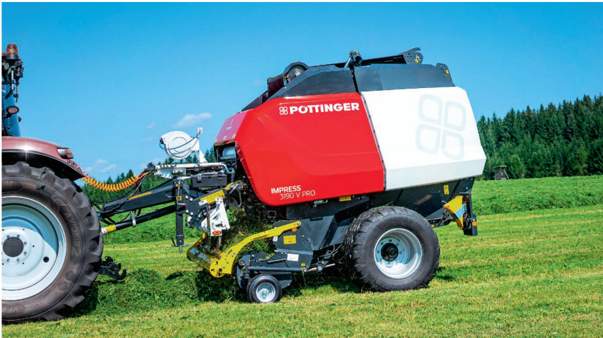
La dernière génération de machines «Impress» est dotée d'une force de pressage plus élevée et d'un nouveau système de liage. Son look a aussi été actualisé. Photo: Idd
