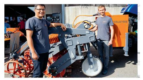
Tim Bögel, directeur de Kronos (à g.), et Marvin Elz, co-propriétaire de la start-up, posent avec le «Rotapull EVO». L'espace au-dessus du rotor est fermé par une bâche pour éviter les projections de terre et de pierres. On distingue à droite le caisson du générateur.
