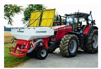
Pöttinger a repensé la trémie frontale de l'«Aerosem 6002 FFD» et la propose en capacités de 1700 ou de 2400 litres. Photo: Idd
