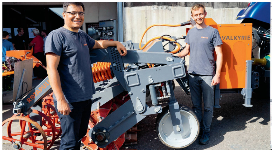
Tim Bögel, directeur de Kronos (à g.), et Marvin Elz, co-proprétaire de la start-up, posent avec le «Rotapull EVO». L'espace au-dessus du rotor est fermé par une bâche pour éviter les projections de terre et de pierres. On distingue à droite le caisson du générateur.
