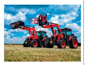
lage des outils, l'activation et la désactivation des amortisseurs et une troisième fonction pour alimenter un moteur hydraulique sans devoir maintenir la pression sur le bouton de commande.
