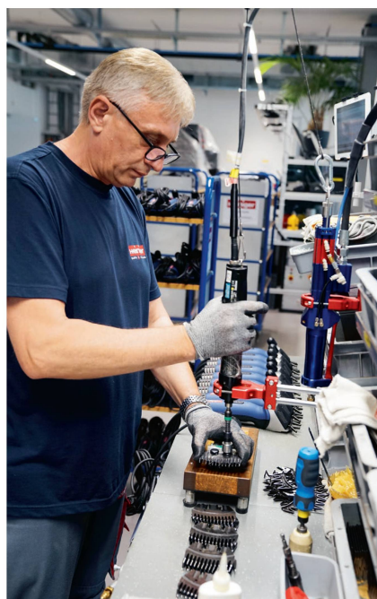
Les peignes et contre-peignes sont assemblés sur des chaînes de montage.
