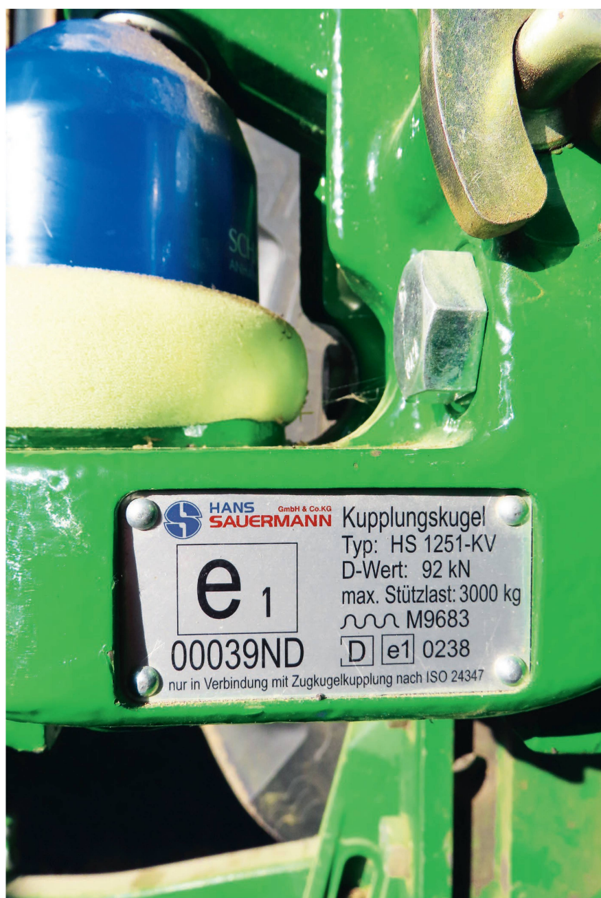
La valeur D (D-Wert) est estampillée sur la plaque constructeur du dispositif d'attelage. Elle s'élève ici à 92 kilonewtons (kN). Photo: Martin Abderhalden
