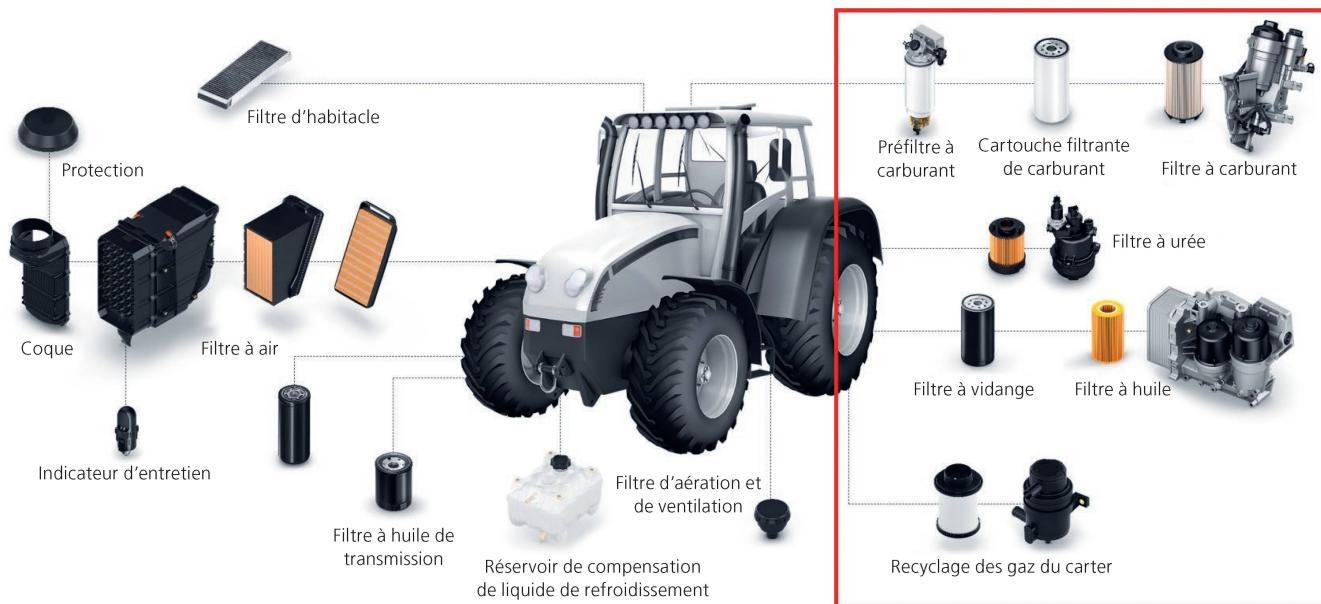
**Sur les propulsions par pile à combustible, les filtres à carburant et à huile (encadré) disparaissent au profit des filtres à air à cathode.**
