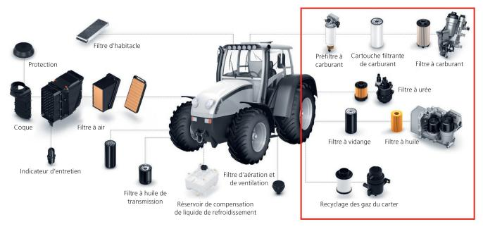
Sur les propulsions par pile à combustible, les filtres à carburant et à huile (encadré) disparaissent au profit des filtres à air à cathode.
