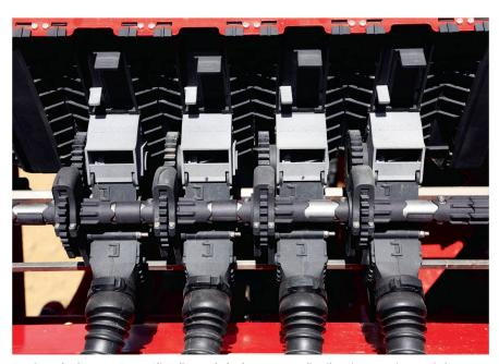
Système de dosage «SmartClip» (à gauche): chaque roue distributrice peut être activée ou désactivée sans outil, avec un clip. La déconnexion électrique d'une moitié de la machine (à droite) est en option.
