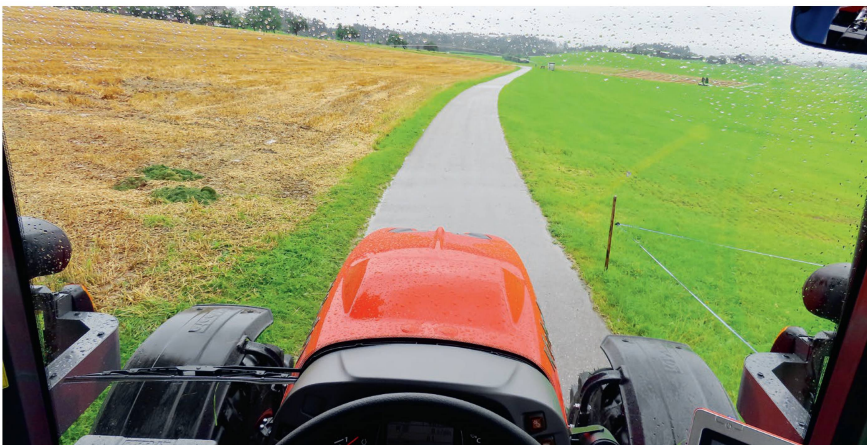
Le capot du compartiment moteur, relativement haut, gêne légèrement la visibilité vers l'avant, mais la cabine à quatre montants bénéficie d'un bon éclairage grâce à son toit vitré et offre une panoramique.
