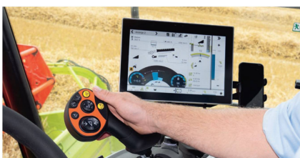
Outre le levier de conduite standard (photo), l'utilisateur dispose d'une poignée «C-Motion». On distingue en arrière-plan le terminal interactif «Cebis».
