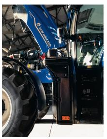
Le remplissage des réservoirs de méthane, dont le taux est contrôlé avec un manomètre, a lieu côté gauche près des marches d'accès à la cabine. Photo: Matthieu Schubnel
