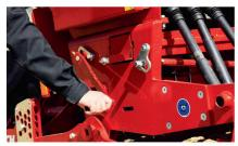
La pression des socs et la profondeur de semis peuvent être réglées séparément à l'aide d'un outil universel.
