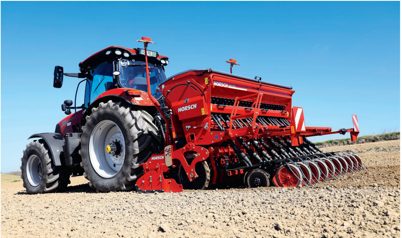
Le premier semoir en ligne mécanique développé par Horsch est équipé d'un système de dosage à entraînement électrique situé sur l'arbre de transmission. Il est livré avec 20 ou 24 socs semeurs, avec des interrangs de 15 ou 12,5 cm. Photos: Johannes Paar
