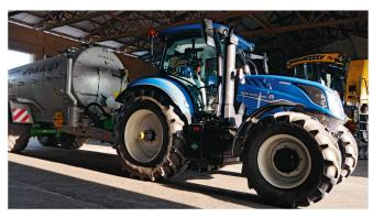
Le «T6.180 Methane» (ici sans réservoirs avant additionnels) affiche des performances équivalentes à celles d'un tracteur T6 animé par un bloc diesel, selon le constructeur. Photo: Matthieu Schubnel
