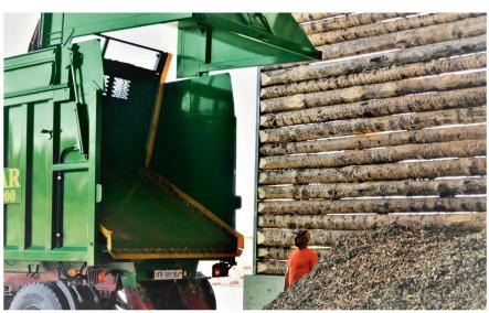
Lors de la phase ultime du déchargement, deux vérins verticaux soulèvent et pivotent la paroi translatée pour décharger les résidus de plaquettes.
