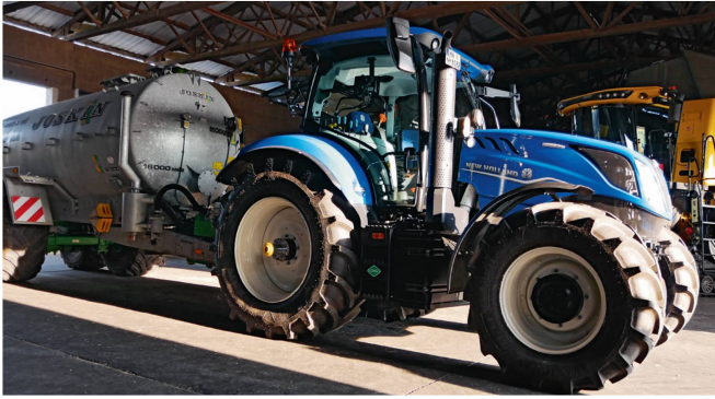
Le «T6.180 Methane» (ici sans réservoirs avant additionnels) affiche des performances équivalentes à celles d'un tracteur T6 animé par un bloc diesel, selon le constructeur. Photo: Matthieu Schubnel
