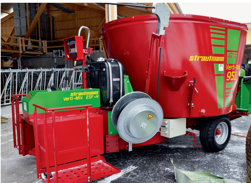
Plusieurs importateurs équipent déjà leurs mélangeuses avec une tête d'entraînement électrique. Photo: Roman Hunger
