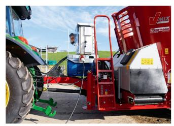
Systèmes d'entraînement hybrides: l'électricité pour mélanger, le tracteur pour se déplacer et distribuer le fourrage. Photo: Roman Engeler
