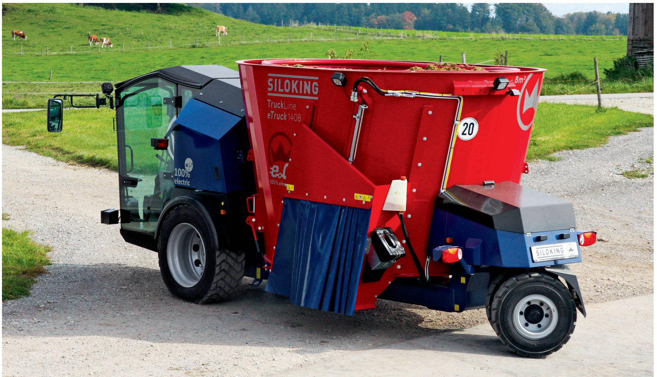
Une réussite remarquable: la mélangeuse automotrice avec son accu plomb/acide. Photo: Siloking
