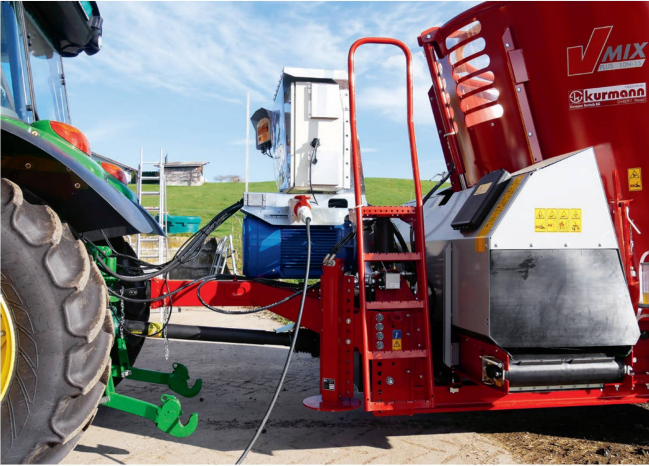
Systèmes d'entraînement hybrides: l'électricité pour mélanger, le tracteur pour se déplacer et distribuer le fourrage. Photo: Roman Engeler
