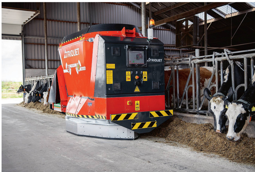
Les systèmes automatiques de distribution du fourrage sont conçus à la base avec un entraînement électrique. Photo: Trioliet
