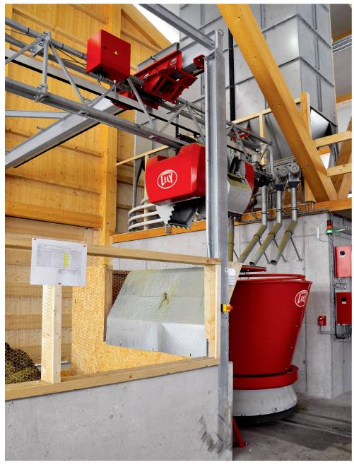
L'allègement de la charge de travail par les systèmes d'alimentation automatiques réside dans le remplissage, le mélange et la distribution des fourrages. Photos: Ruedi Hunger
