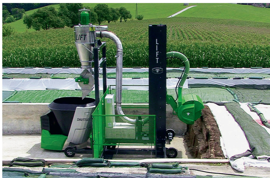
Le fourrage reste dans le silo-tranchée et le robot d'affouragement est approvisionné automatiquement par le dispositif de prélèvement. Photo: Wasserbauer
