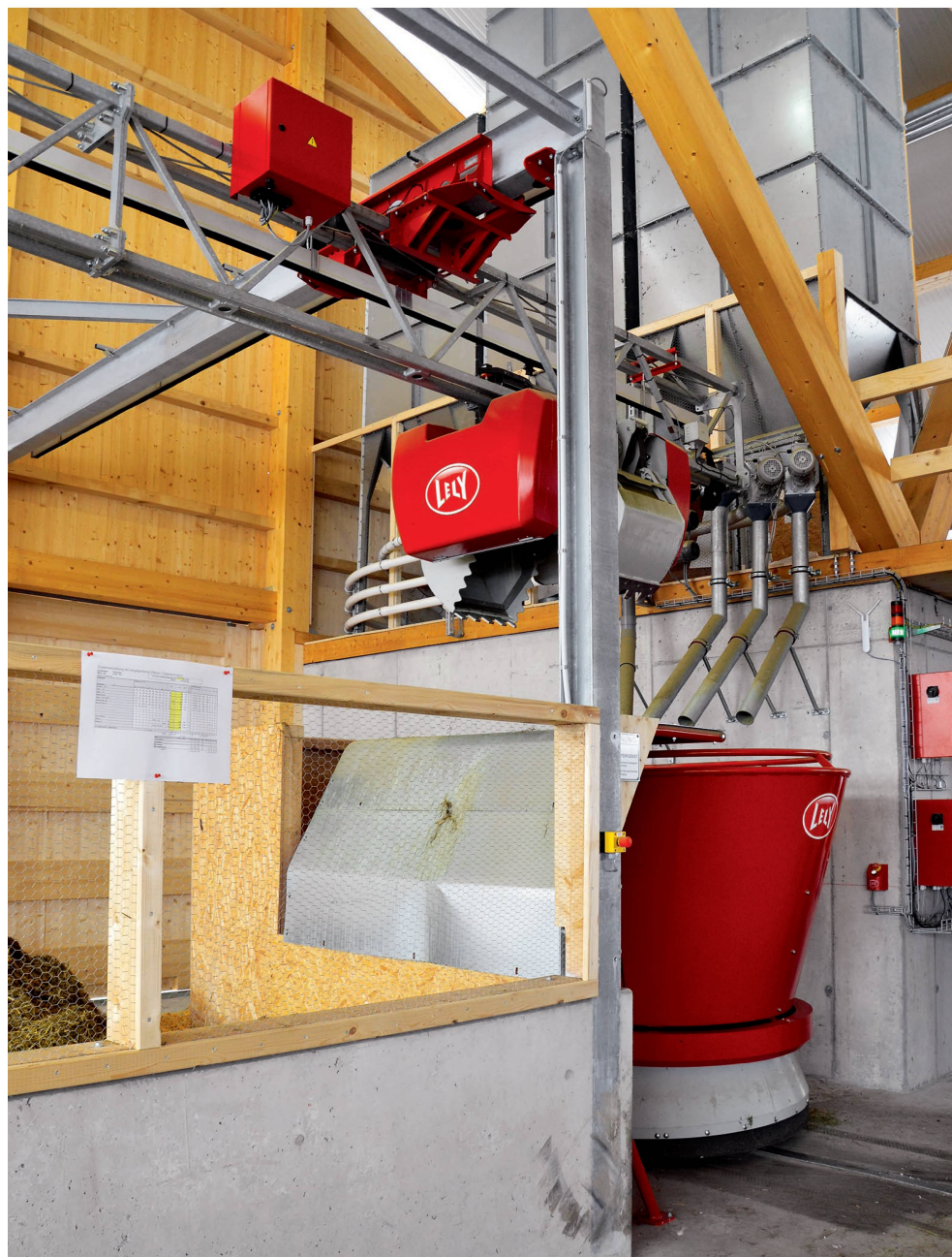
L'allègement de la charge de travail par les systèmes d'alimentation automatiques réside dans le remplissage, le mélange et la distribution des fourrages. Photos: Ruedi Hunger
