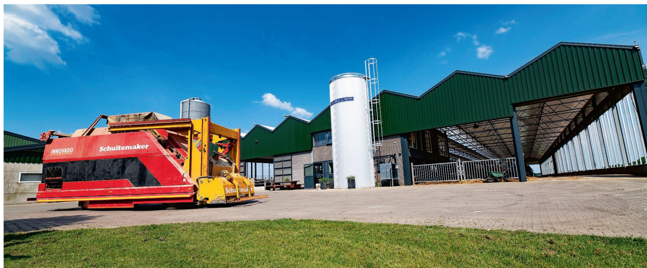
Directement du silo à la vache. Le chemin est donné par des transpondeur ou un signal GPS RTK. Photo: Schuitemaker
