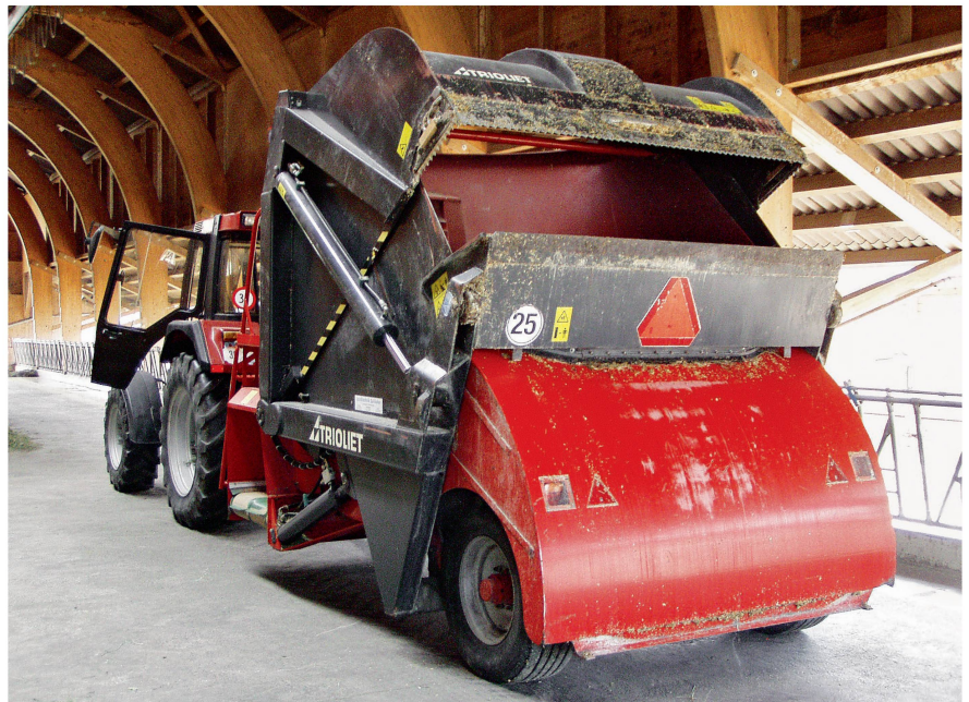
Les mélangeuses à vis verticales sont également disponibles avec auto-remplissage.
