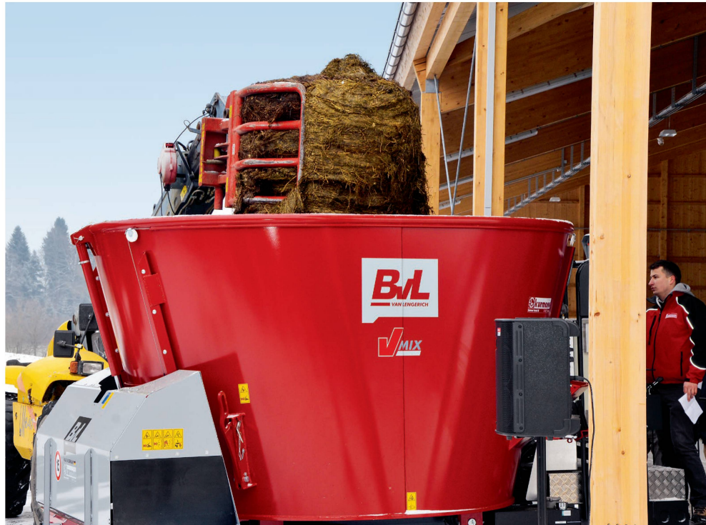
Les mélangeuses à vis verticales sont généralement approvisionnées par un équipement externe. Photo: Ruedi Hunger
