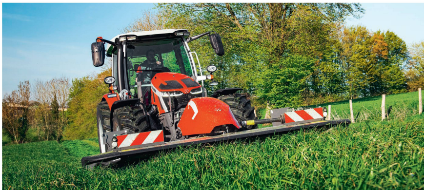
La faucheuse frontale la plus récente, la «MF DM 316 FP», d'une largeur de travail de 3,1 mètres, peut être livrée avec un conditionneur à dents ou à rouleaux.
