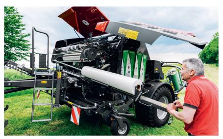
Le système «Comfort Load» et le long bras de chargement facilitent le chargement et l'installation des rouleaux de filet ou de film de liage dans la machine.
