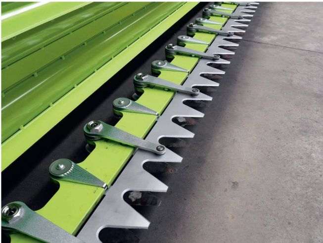
Chaque biellette supérieure guide trois couteaux, conférant au système une bonne stabilité.
