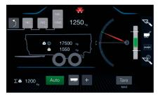
Le «MF E-Loader» affiche à l'écran la position du chargeur, le poids des charges et les paramètres d'automatisation de la pelle ou de la fourche. Il sert aussi à programmer des séquences automatiques pour certains cycles de chargement.
