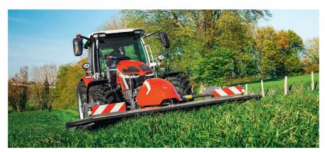
La faucheuse frontale la plus récente, la «MF DM 316 FP», d'une largeur de travail de 3,1 mètres, peut être livrée avec un conditionneur à dents ou à rouleaux.
