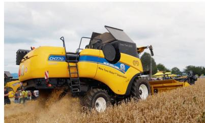
7.70» avec le système «Crossover Harvesting» faisait aussi sa première sortie. Cet organe associe la technique de séparation «Twin Rotor» et celle de batteage conventionnelle New Holland, ce qui devrait permettre d'augmenter le débit. La «CH 7.70» se positionne entre les moissonneuses-batteuses conventionnelles de milieu de gamme et les modèles rotatifs de New Holland.
