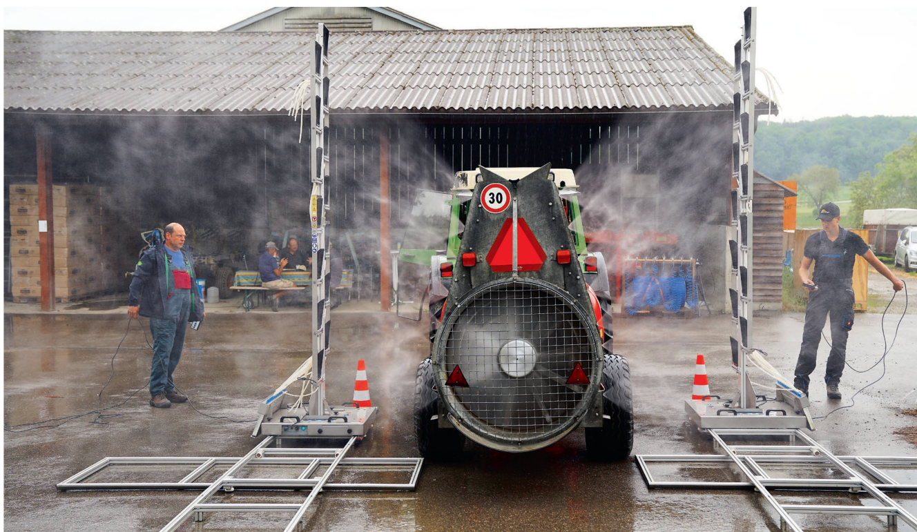
Le nouveau banc d'essais pour les tests de pulvérisateurs et atomiseurs viticoles et arboricoles avec ses parois munies de réceptacles verticaux. Ici un turbo-pulvérisateur pour vergers. À gauche, Christian Meyer. Photos: Dominik Senn
