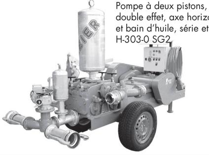
Pompe à deux pistons, double effet, axe horizontal et bain d'huile, série et type H-303-0 SG2.
