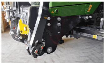
Le tracteur peut être équipé d'usine d'un système hydraulique frontal Sauter.
