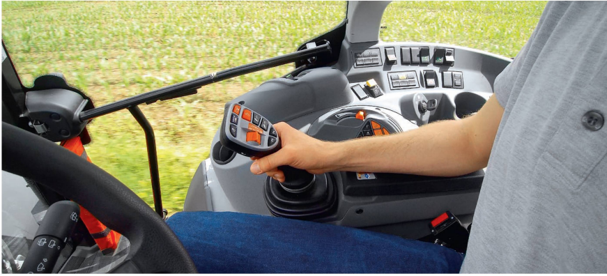
La console latérale est très fonctionnelle dans la définition «Cis+», avec levier multifonctions et distributeurs électriques.
