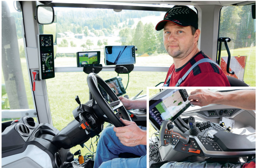
Grâce au nouvel accoudoir avec monolevier Isobus et écran tactile monté sur le siège suspendu et inclinable à 45°, le conducteur accède aisément à l'ensemble des commandes du tracteur MF «8S».
