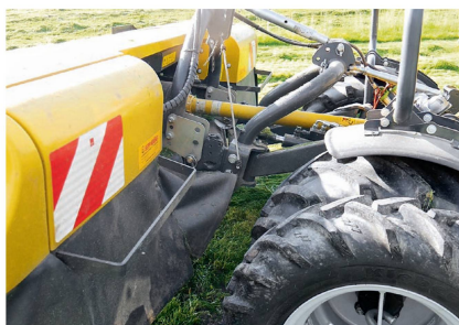
Le relevage frontal dispose d'un débattement latéral hydraulique de 19 cm vers la gauche et vers la droite.
