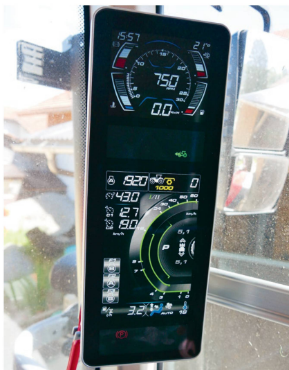
Regroupant les informations relatives au moteur et à la transmission, le tableau de bord numérique du «8S» monté de série prend place non pas sous le volant, mais au niveau du montant avant droit de la cabine.
