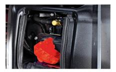
La batterie se situe sous l'accès de la cabine, à droite, et dispose dorénavant d'une borne positive pour un pontage direct.
