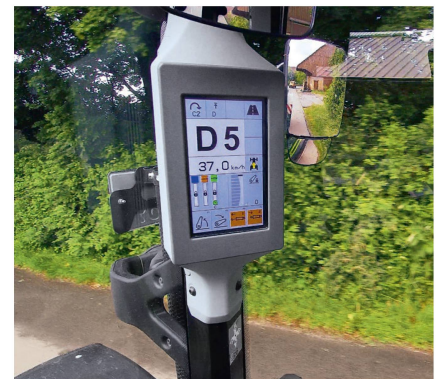
L'afficheur 7 pouces sur le montant droit fournit des informations complètes sur la transmission, les distributeurs électroniques et l'affectation des touches de fonction.
