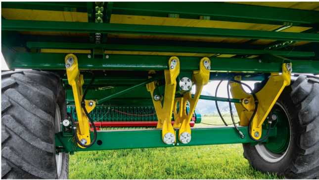
Essieu extensible en positions «route» (à gauche) et «terrain» (à droite): un cylindre hydraulique est intégré au tube jaune à section carrée. La géométrie directionnelle garantit que les deux moitiés d'essieu se déplacent toujours de manière synchrone pendant la poussée.
