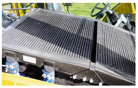
Un grand filtre à air équipé d'un préfiltre assure le refroidissement du moteur. Un inverseur de ventilation pour le nettoyage est installé de série.
