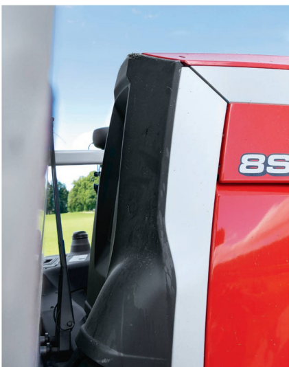
Le MF «8S» se distingue entre autres par son espace entre le compartiment moteur et le pare-brise, par lequel est aspiré l'air alimentant le moteur, limitant ainsi l'encrassement des grilles du capot.
