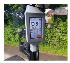
L'afficheur 7 pouces sur le montant droit fournit des informations complètes sur la transmission, les distributeurs électroniques et l'affectation des touches de fonction.
