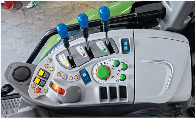
La console latérale comporte trois leviers de distributeurs à commandes mécaniques et une soupape de réglage électrique.
