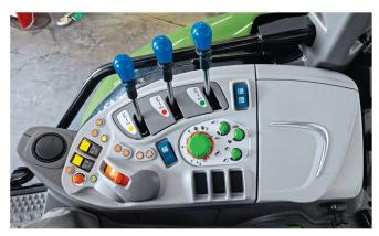
La console latérale comporte trois leviers de distributeurs à commandes mécaniques et une soupape de réglage électrique.
