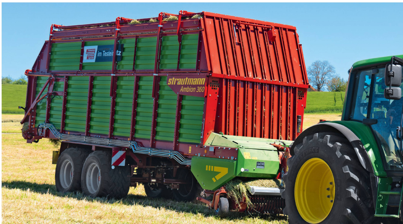
La remorque autochargeuse «Ambion 360» de Strautmann dispose d'un volume de chargement de grande capacité. La partie supérieure de la structure est fermée par de solides profilés en acier. Photos: Roman Engeler
