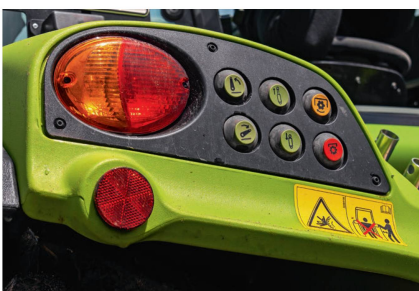
La commande extérieure du relevage arrière, d'un distributeur électronique et de la prise de force peut s'effectuer sur les deux garde-boues.
