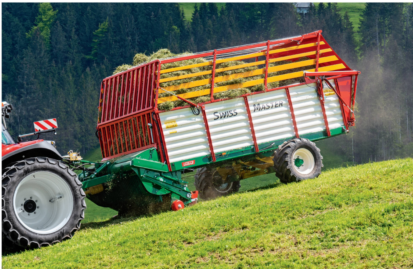
L'autochargeuse «Swiss Master» est basée sur le principe du ramassage arrière que le constructeur Löönd utilise déjà pour ses modèles portés, adaptés aux transporters. Photos: Roman Engeler
