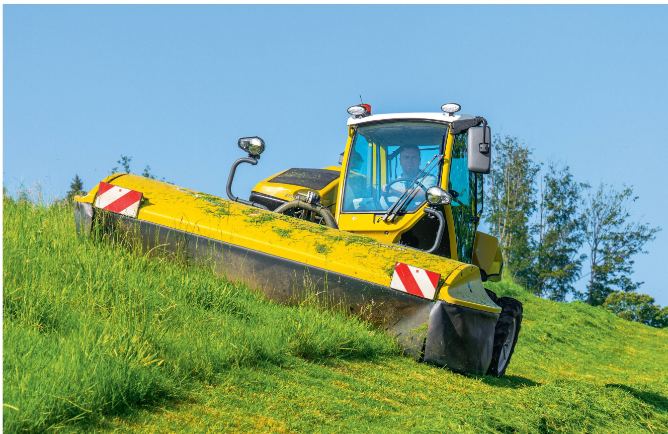
La cabine de la faucheuse à deux essieux Rigitrac «SKH 60» peut compenser des pentes jusqu'à 30 %.
