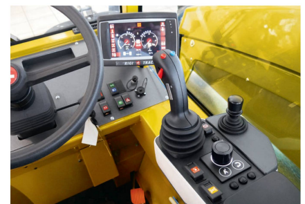
L'écran tactile, le joystick et les boutons rotatifs contribuent au confort et à la vitesse d'utilisation du véhicule.
