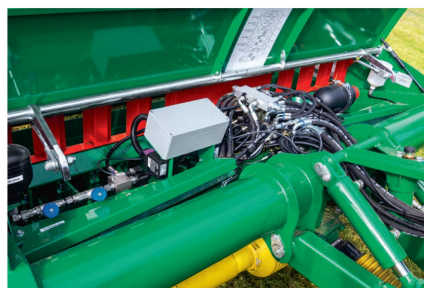
Les composants de la commande (hydraulique) sont logés dans la boîte au-dessus du module râteleur et du canal de ramassage.
