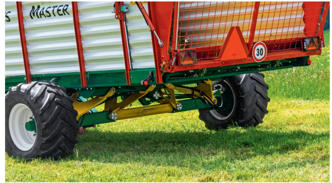
Essieu extensible en positions «route» (à gauche) et «terrain» (à droite): un cylindre hydraulique est intégré au tube jaune à section carrée. La géométrie directionnelle garantit que les deux moitiés d'essieu se déplacent toujours de manière synchrone pendant la poussée.
