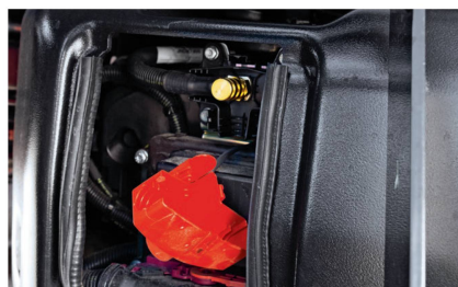
La batterie se situe sous l'accès de la cabine, à droite, et dispose dorénavant d'une borne positive pour un pontage direct.
