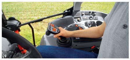
La console latérale est très fonctionnelle dans la définition «Cis+», avec levier multifonctions et distributeurs électriques.
