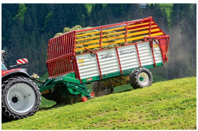
L'autochargeuse «Swiss Master» est basée sur le principe du ramassage arrière que le constructeur Lüönd utilise déjà pour ses modèles portés, adaptés aux transporters. Photos: Roman Engeler
