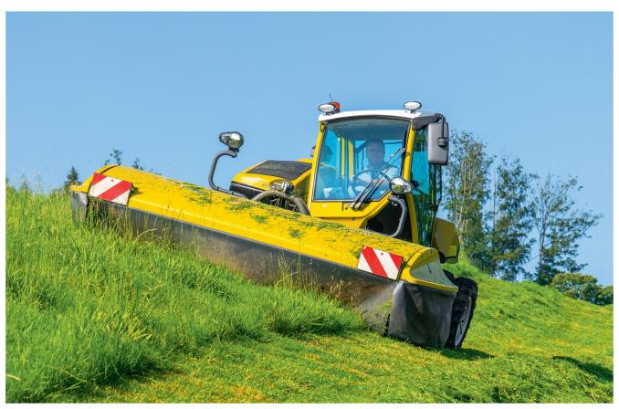
La cabine de la faucheuse à deux essieux Rigitrac «SKH 60» peut compenser des pentes jusqu'à 30%.
