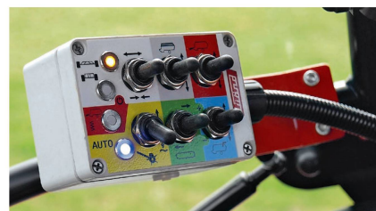
Toutes les fonctions peuvent être contrôlées via ce panneau de commande optionnel. Des témoins lumineux indiquent, par exemple, l'état d'activation du timon automatique articulé ou la position de l'essieu extensible.
