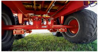
Le châssis de la remorque repose sur une suspension tandem boggie à deux essieux avec essieu suiveur verrouillable. Le modèle essayé est chaussé de pneumatiques de dimensions «620/40R22.5».
