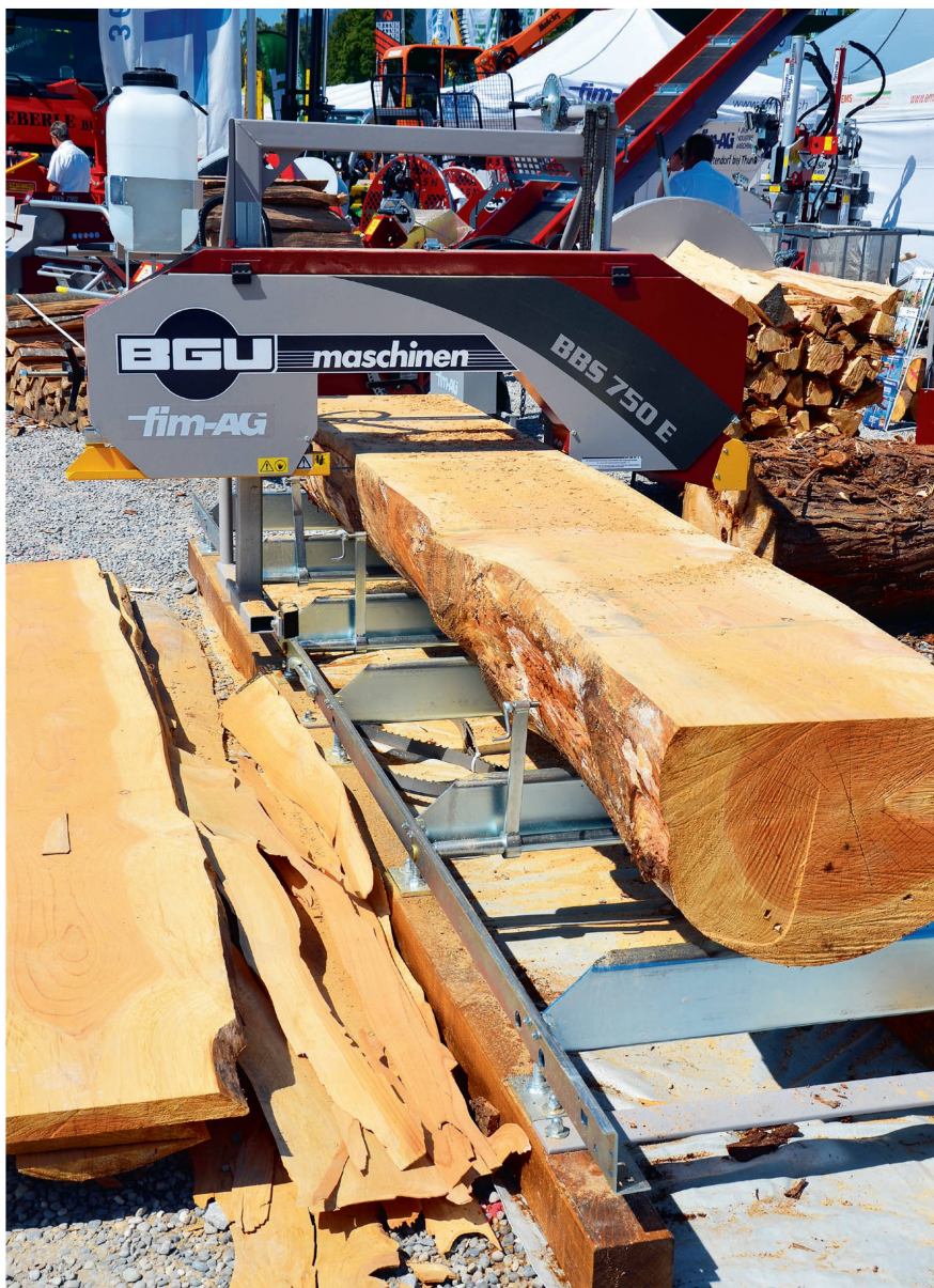
La condition préalable à des performances et une qualité de coupe élevées est une fixation solide des pièces de bois sur le support de sciage. Photo: Ruedi Hunger
