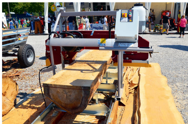
Toutes les scieries comparables peuvent être montées sur châssis et se transporter avec un pick-up ou un tracteur. Photo: Ruedi Hunger
