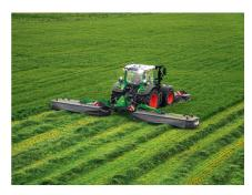
Selon Fendt, la nouvelle génération de faucheuses «Slicer F» et arrière double «Slicer 860/960» ont été allégées respectivement jusqu'à 60 et 360 kg pour réduire le besoin en puissance et préserver les sols.
