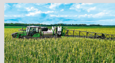
Non proposé en Europe, le nouveau porte-outils «Rogator 900» se distingue des autres automoteurs de la gamme par sa capacité à pulvériser des produits phytosanitaires ou à épandre de l'engrais.
