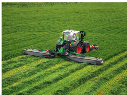
Selon Fendt, la nouvelle génération de faucheuses «Slicer F» et arrière double «Slicer 860/960» ont été allégées respectivement jusqu'à 60 et 360 kg pour réduire le besoin en puissance et préserver les sols.
