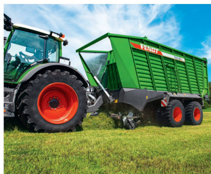
Les deux remorques autochargeuses de la nouvelle gamme «Tigo VR» combinent l'unité de chargement éprouvée de la «Tigo PR» et le volume de caisse de la «Tigo XR».
