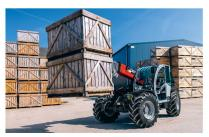
Massey Ferguson lance une nouvelle gamme de chargeurs télescopiques dotés d'une cabine revue et améliorée pour le confort de l'opérateur. La gamme comprend six modèles, du compact «MF TH 6030» au «MF TH 8043» avec une capacité de levage maximale de 4300 kg, et une hauteur de levage de 7,5 mètres. Il peut être équipé d'un godet de 3500 litres.
