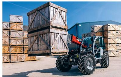
Massey Ferguson lance une nouvelle gamme de chargeurs télescopiques dotés d'une cabine revue et améliorée pour le confort de l'opérateur. La gamme comprend six modèles, du compact «MF TH 6030» au «MF TH 8043» avec une capacité de levage maximale de 4300 kg, et une hauteur de levage de 7,5 mètres. Il peut être équipé d'un godet de 3500 litres. Des améliorations significatives ont été apportées à la transmission hydrostatique, qui comprend désormais un
