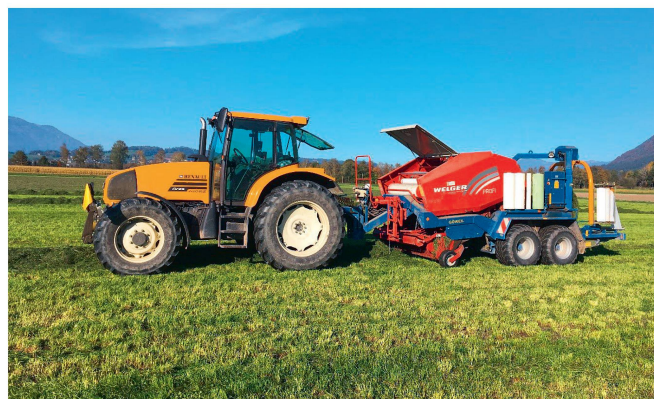
L'«Ares 620 RZ» et son six-cylindres de 120 chevaux devant la presse-enrubanneuse. Le long empattement du tracteur est un indice de la répartition équilibrée de ses masses.
