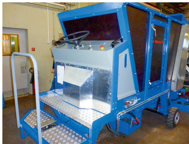
Cette distributrice à fourrage est entraînée par un moteur électrique.
