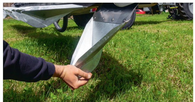
Le lisier s'écoule à travers un «collecteur triangulaire» fixé à la rampe par une tôle en inox suspendue et terminée par un patin en Hardox.
