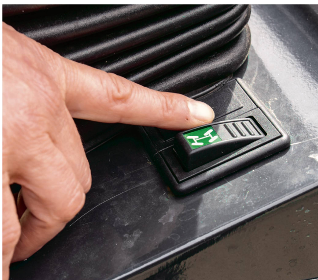
La sélection du mode de direction des roues intervient en appuyant sur cet interrupteur à bascule à droite de la colonne du volant.
