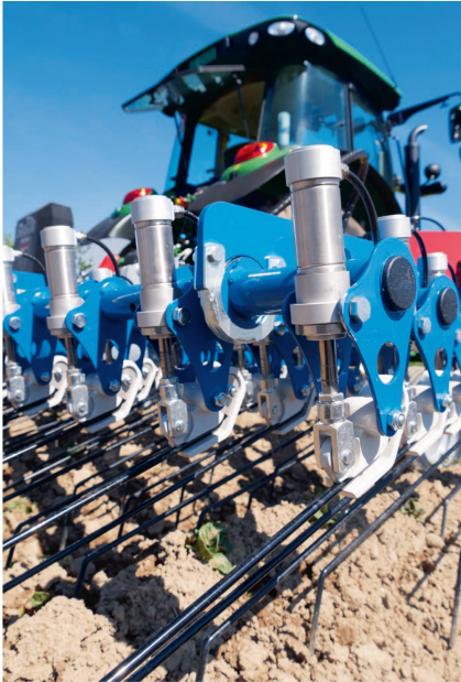
Chaque dent est pourvue d'un vérin pneumatique capable de produire une force d'appui allant jusqu'à 5 kg.
