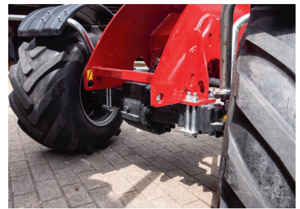
Les essieux sont de marque Comer, les roues ont un angle de braquage de 38 degrés.
