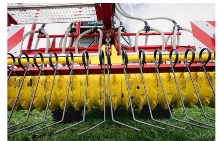
Vue arrière en position de transport. On aperçoit la chaîne et les dents repliées de la herse de recouvrement.
