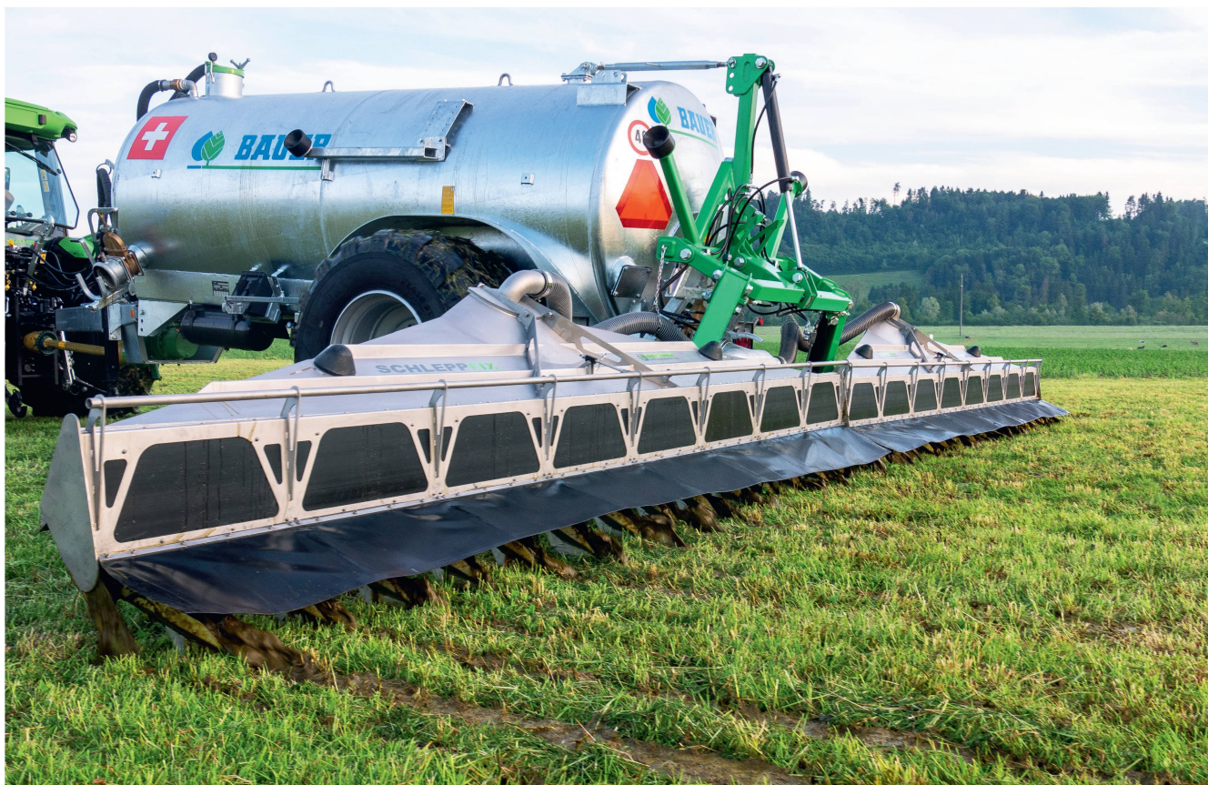
Dans sa version de 9 mètres, le répartiteur de lisier «Schlepp-Fix» présente 30 descentes espacées de 30 cm. Photos: Roman Engeler
