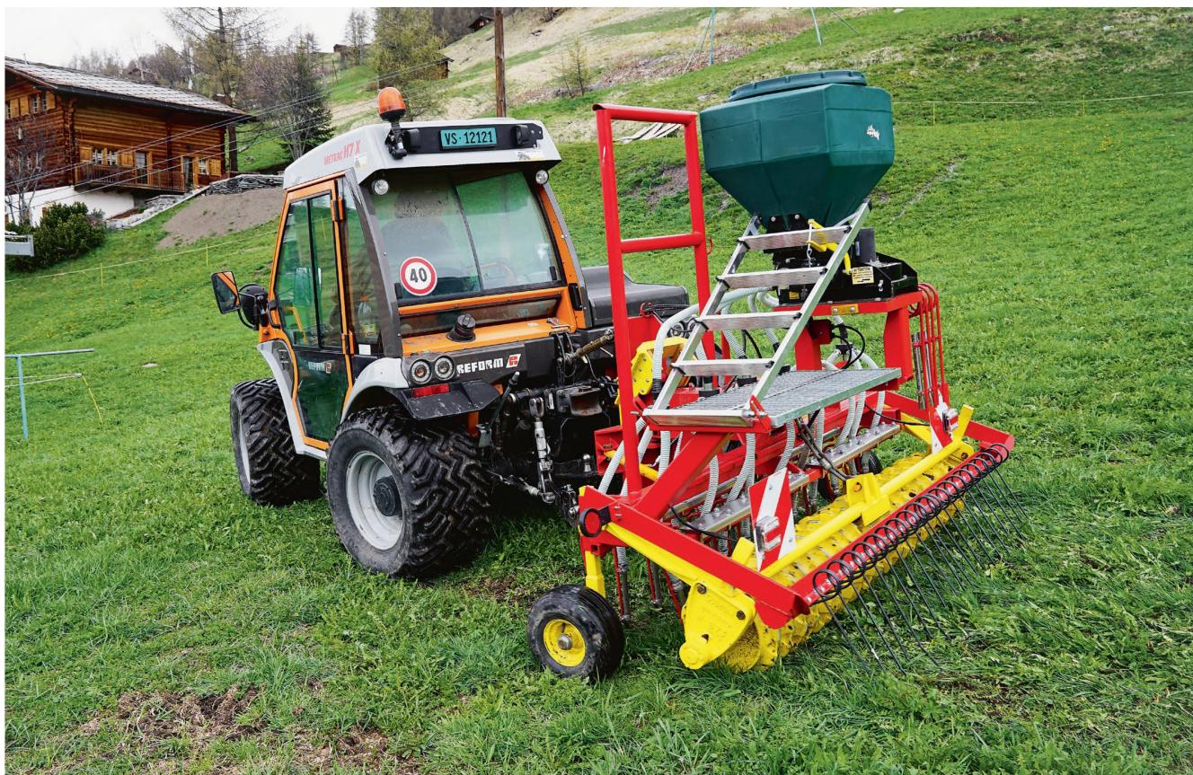
D'un poids de 650 kg seulement, le semoir à sursemis de fabrication maison de l'exploitation de Nicolas Gaudin, à La Forclaz, dans le canton du Valais, est en position de suivi dans les traces du Reform «Metrac H7 X». Photos: Dominik Senn
