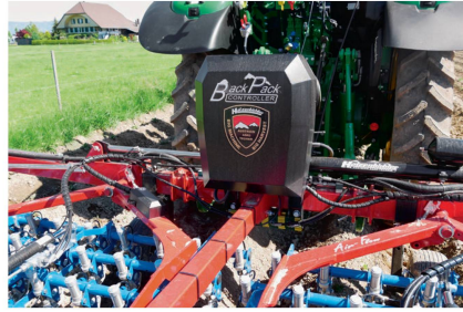
Le «Pack-Controller» contrôle la pression et alimente les vérins pneumatiques en air comprimé.
