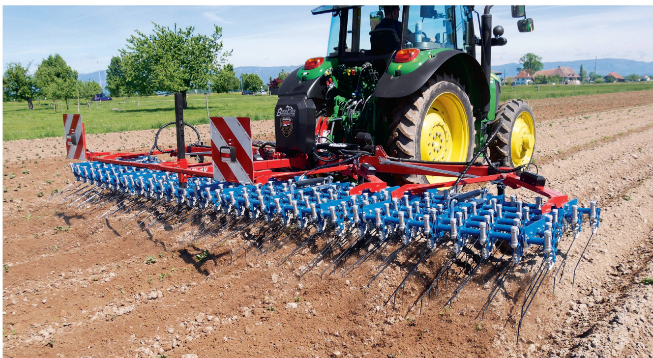
Une force d'appui des étrilles sur le sol régulière sur toute la largeur de la machine: la herse-étrille Hatzenbichler de 6 mètres équipée du système «AirFlow» est en pleine intervention dans un champ de pommes de terre. Photos: Heinz Röthlisberger
