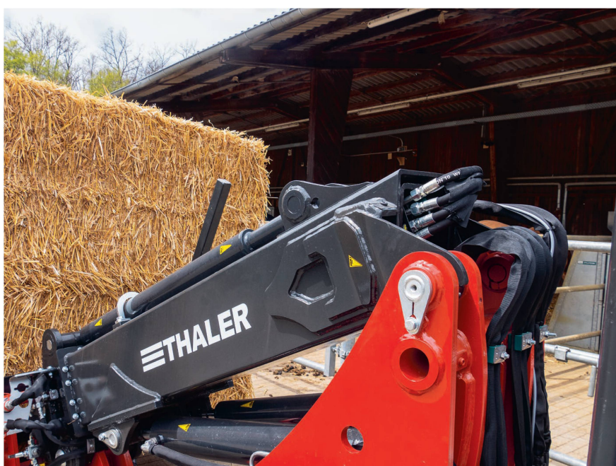
Le bras de levage est actionné par un cylindre de levage et un cylindre de compensation.
