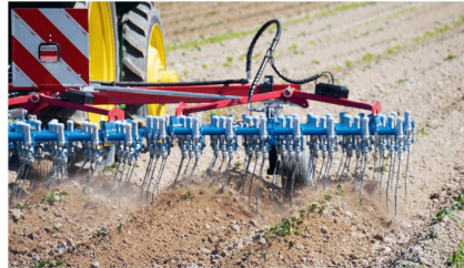
Grâce à la force d'appui générée, les étrilles atteignent les flancs et les espaces entre les buttes.
