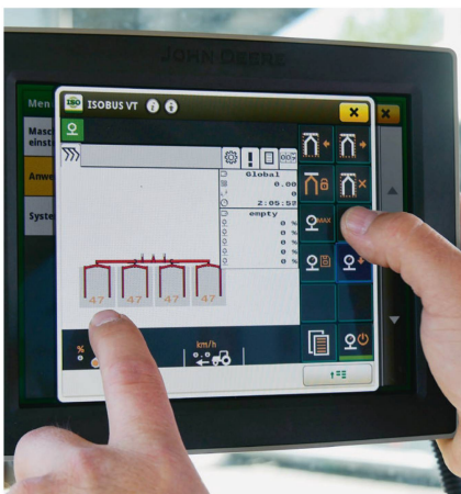
Chaque compartiment (de 1,5 mètre de large) de la herse se règle séparément sur le terminal Isobus du tracteur.
