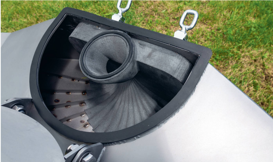
La pièce en matériau synthétique réalisée sur une imprimante 3D est le cœur du «Schlepp-Fix»: le lisier provenant de l'anneau est réparti sur toute la largeur de travail grâce à la surface ondulée.
