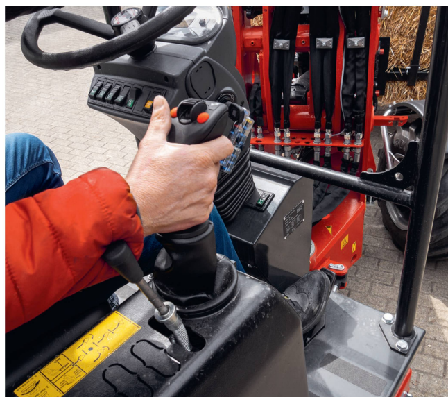
Le joystick et le levier actionnant le troisième circuit de hydraulique s'enfoncent verticalement et peuvent se verrouiller.
