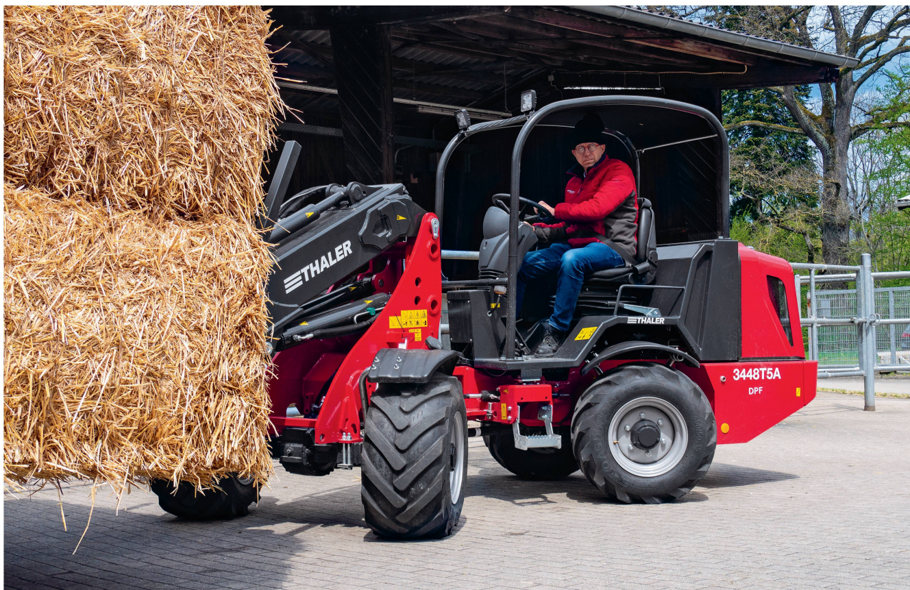
Thaler marie sur ses chargeurs portant l'intitulé «5A», une articulation centrale avec une direction à rotules (à géométrie Ackermann) sur les quatre roues. Photos: Roman Engeler
