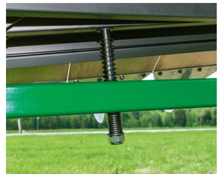
Le point de balancier central amorti par des ressorts permet à chaque unité de pivoter.
