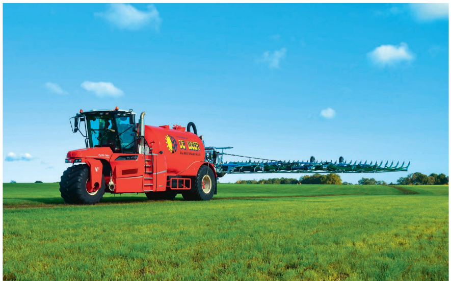
L'«Hydro Trike» de Vervaet permet de limiter le nombre d'impacts de roues par unité de surface grâce à la disposition centrale de la roue directrice.
