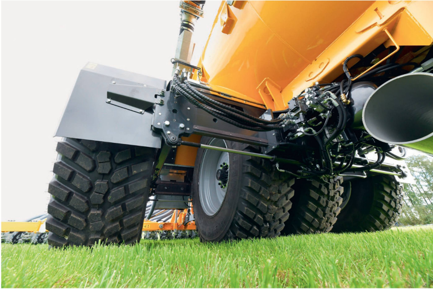
Les essieux télescopiques permettent de réduire le nombre de pics de pression dans les traces du tracteur, tout en améliorant le comportement dans les déclivités. Photos: ldd
