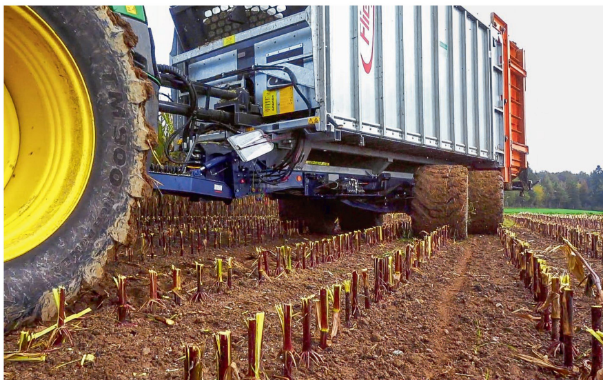
Les lourds équipements peuvent avoir un effet «travail du sol» peu souhaitable. L'avance «en crabe» réduit la proportion de surface subissant des passages multiples. Photo: Ruedi Burkhalter
