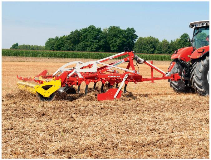
Bien que la déchaumeuse permette un ameublissement en profondeur, une grande partie de la paille demeure dans un horizon de 0 à 5 cm. Photo: Pöttinger
