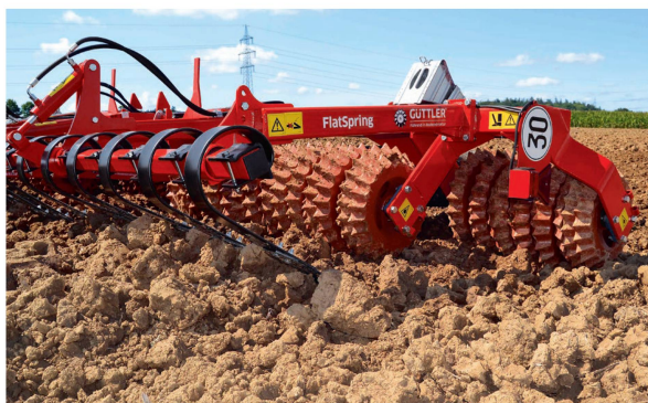
Rouler la terre constitue une condition essentielle pour le maintien de l'eau dans le sol. Photo: Gütli
