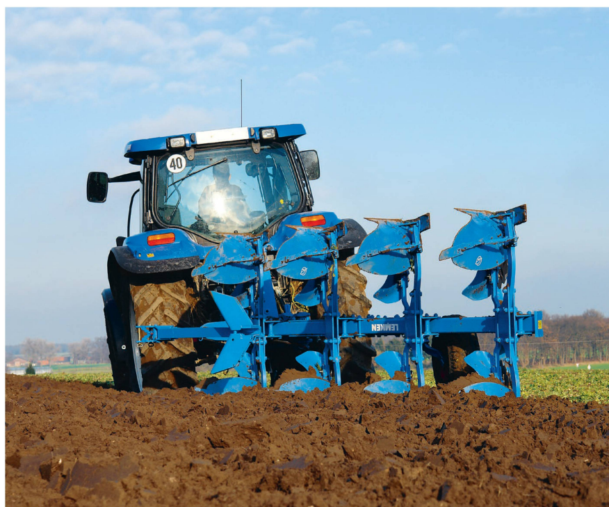
La charrue fait remonter en quantité la terre humide à la surface. Celle-ci s'assèche ensuite et l'eau est perdue. Photo: Lemken
