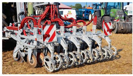
La fertilisation des bandes avec du lisier sous la surface du sol peut être effectuée avant ou pendant le semis. Photo: Ruedi Hunger
