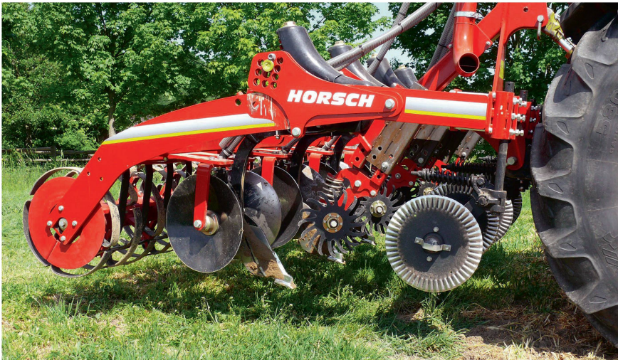
Structure de base avec les disques ouvreurs, les chasses-débris, les dents d'ameublissement et les disques butteurs. Photo: Idd
