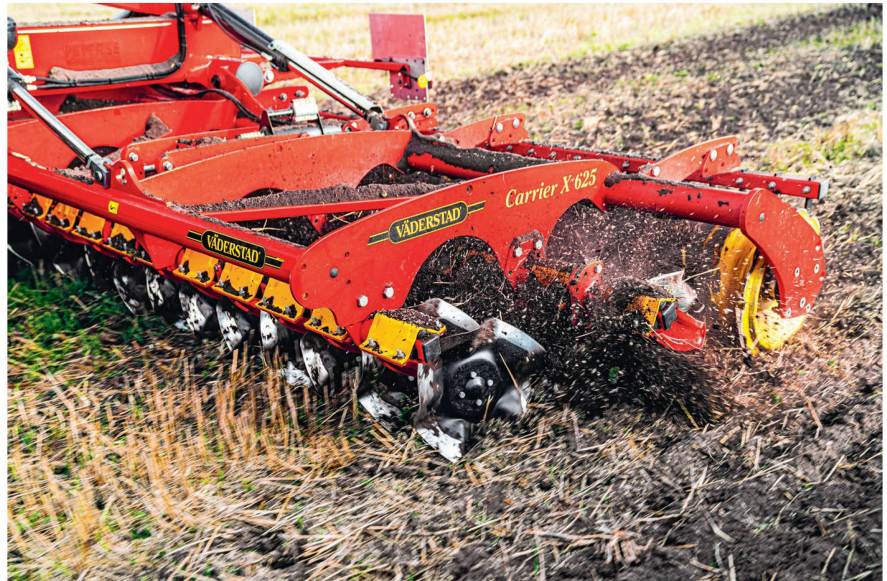
La forme spéciale des disques CrossCutter et leur profil de 11 cm de large permettent une découpe à 2 à 3 cm de profondeur sur toute la surface. Photo: Väderstad
