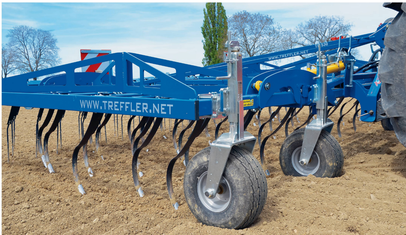
Le design spécial de ces dents permet un travail sans bourrage par les résidus de récolte. Photo: Ruedi Hunger
