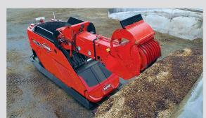
veillent à la propreté du couloir. Un moteur à combustion d'une puissance de 42 kW assure l'entraînement. Une version hybride sera bientôt disponible. La navigation se fait à l'extérieur avec le GPS-RTK et avec le système Lidar dans les bâtiments.
