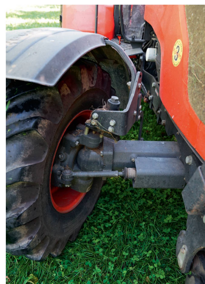
Le dispositif breveté « Bi-Speed-Automatic » et le double engrenage conique offrent un angle de braquage généreux pour tourner dans un espace réduit.
