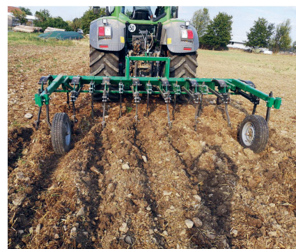
Les outils du buttoir sont protégés par des goupilles de cisaillement de sécurité.
