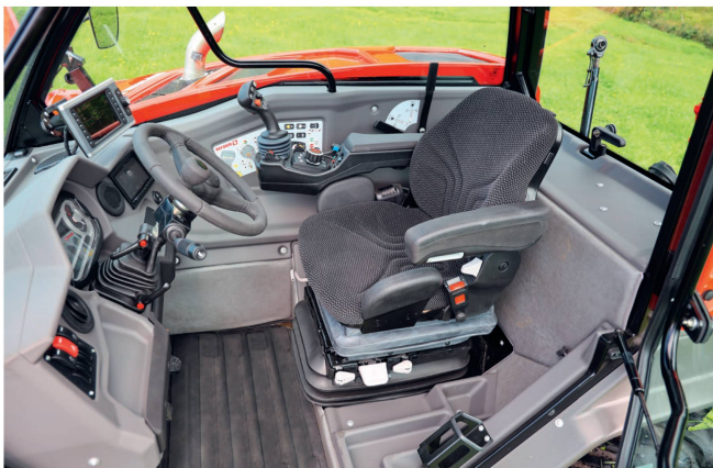
Le poste de conduite est moderne, bien agencé, avec des commandes groupées sur le confortable accoudoir.
