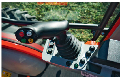
La plupart des fonctions hydrauliques, du relevage et des prises de force sont gérées au moyen du joystick.
