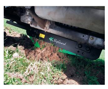
Le dépannage d'un véhicule freiné avec le «SlipGuard» peut être un peu laborieux, car le système se remplit de terre.
