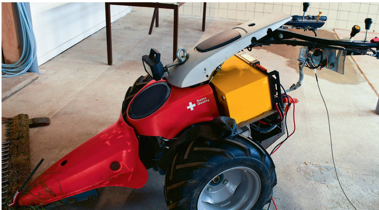
Un aspect inhabituel: un kit électrique à la place du moteur Vanguard habituel. Photos: Ruedi Hunger
