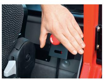
Le dispositif d'arrêt d'urgence peut être déclenché électriquement (fixation magnétique) ou mécaniquement par traction sur un câble.
