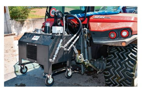
Pour les faucheuses à deux essieux jusqu'à 2000 kilos, le dispositif d'entraînement peut aussi servir de contrepoids arrière pour l'attelage à trois points.
