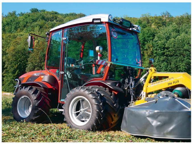
Le centre de gravité bas et la position centrale du poste de conduite, ainsi que les roues jumelées, font de ce véhicule d'environ 2,9 tonnes un véritable concurrent de la faucheuse à deux essieux. Photos: Roman Engeler
