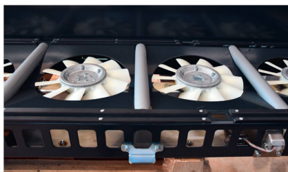
La particularité originale est un système de vide (g.) surmonté d'un tapis perforé.
