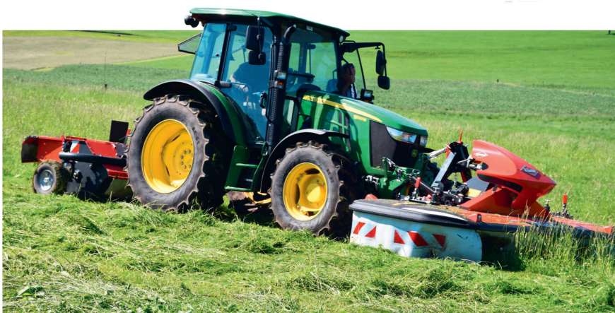
La faucheuse peut également être utilisée en association avec un conditionneur à l'arrière du tracteur.
