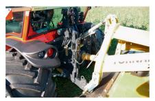
La pompe optionnelle débite 52 l/min (44 l/min pour la pompe d'origine). Elle alimente quatre distributeurs.
