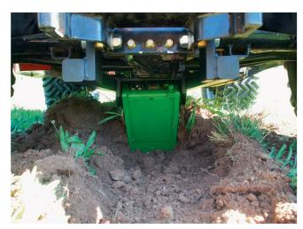
Selon le sens de la marche, l'un des deux clapets massifs s'enfonce dans le sol comme une ancre et arrête le véhicule.
