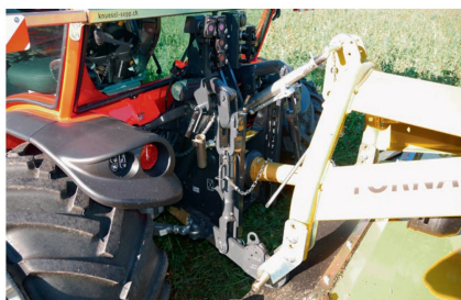
La pompe optionnelle débite 52 l/min (44 l/min pour la pompe d'origine). Elle alimente quatre distributeurs.
