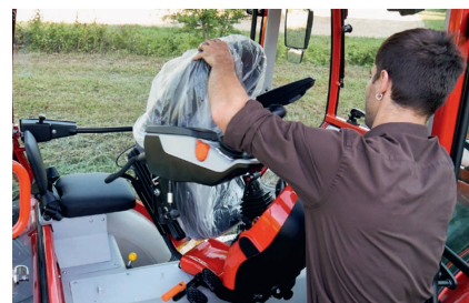
Une vingtaine de secondes suffisent pour inverser le poste de conduite, volant et tableau de bord compris.
