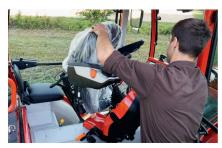
Une vingtaine de secondes suffisent pour inverser le poste de conduite, volant et tableau de bord compris.
