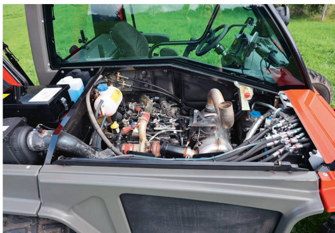
Reform a changé de motoriste et les nouveaux «Metrac» sont dotés d'un 4 cylindres Perkins de 75 chevaux à 2200 tr/min.
