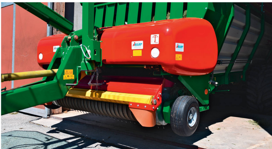
Détail important : les protections latérales en caoutchouc empêchent le fourrage court de s'échapper en pente.
