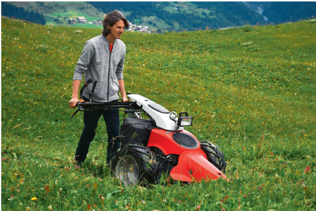
L'opérateur est « normalement » exposé aux gaz d'échappement, une contrainte qui disparaît avec le moteur électrique.
