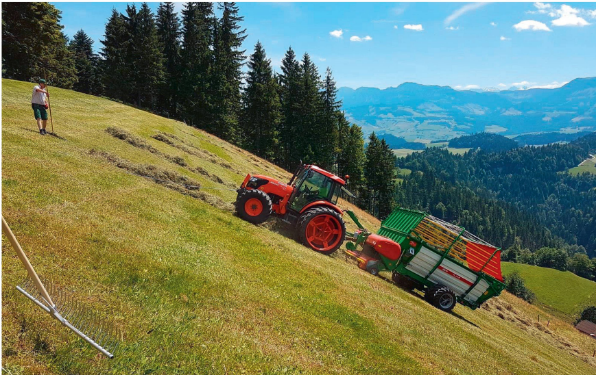
Pour charger le foin sur un terrain escarpé, la famille Pfulg utilise le Kubota «M9540» et la remorque surbaissée «TL23K» d'Agrar avec un essieu directionnel. Photos : ldd
