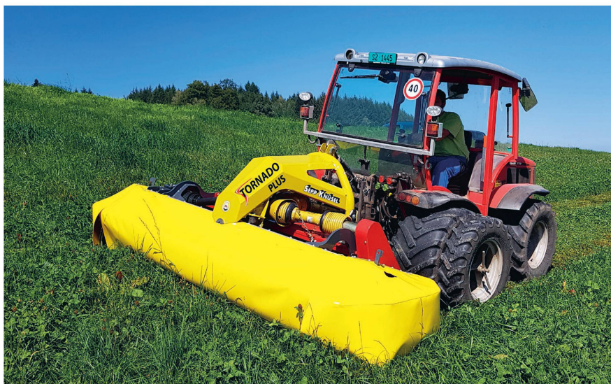
Le tracteur 4x4 avec poste inversé peut remplacer la faucheuse à deux essieux. Photo: Knüsel
