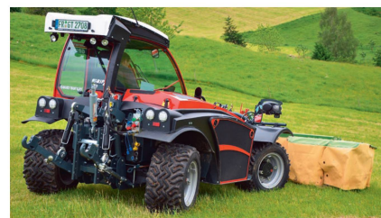
L'association d'une faucheuse à deux essieux et d'une faucheuse frontale constitue un véhicule performant en pente.
