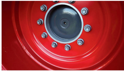
L'essieu a été élargi par une bague d'écartement pour éviter que la suspension de la cabine touche la roue.
