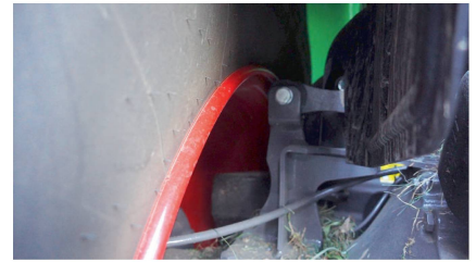
L'essieu a été élargi par une bague d'écartement pour éviter que la suspension de la cabine touche la roue.
