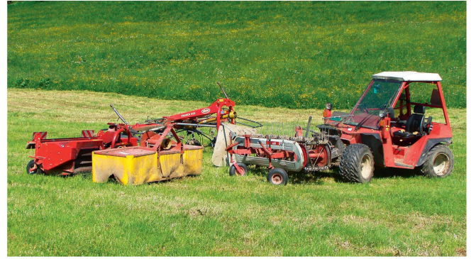
Les faucheuses à deux essieux sont de véritables porte-outils et la gamme d'accessoires est étendue en conséquence.
