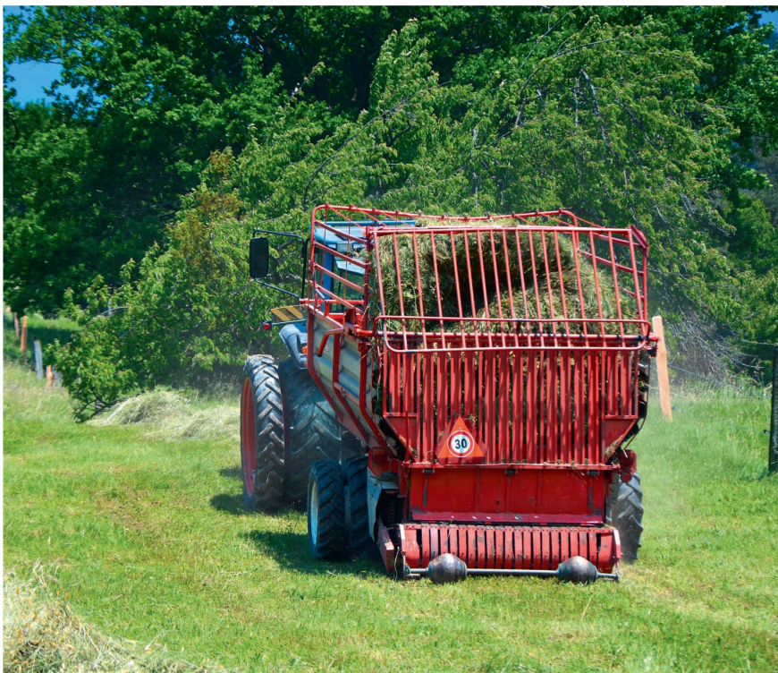
L'ensemble tracteur/autochargeuse ne devient vraiment « montagnard » qu'avec l'essieu moteur.
