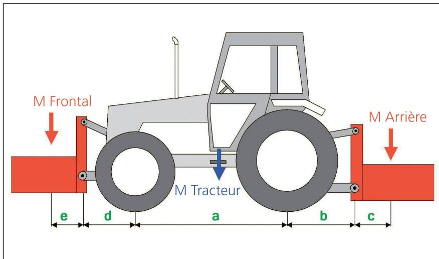
Le calculateur de charges à l'essieu permet d'estimer facilement les poids de cinq configurations d'attelage différentes. Le véhicule, ou au moins l'un de ses essieux, est surchargé si les valeurs obtenues sont supérieures à celles autorisées sur le tracteur. Schéma: Agroscope
