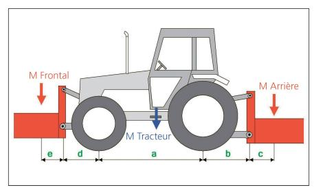
Le calculateur de charges à l'essieu permet d'estimer facilement les poids de cinq configurations d'attelage différentes. Le véhicule, ou au moins l'un de ses essieux, est surchargé si les valeurs obtenues sont supérieures à celles autorisées sur le tracteur. Schéma: Agroscope
