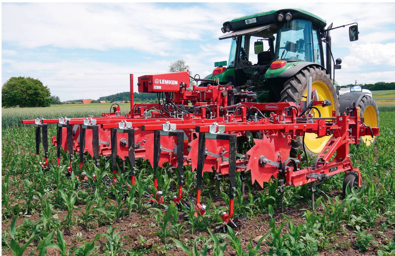
La « EC-Weeder » est adaptée à toutes les cultures en ligne et peut être configurée selon les souhaits du client. Photos : Roman Engeler
