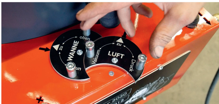
Vannes-robinets sur le pupitre de commande pour choisir entre aspiration et refoulement et pour sélectionner le point d'aspiration.
