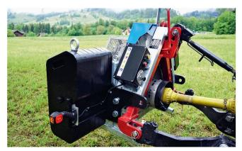
Le module de gestion électronique permet d'adapter aisément la puissance de freinage maximale au moyen d'un potentiomètre.
