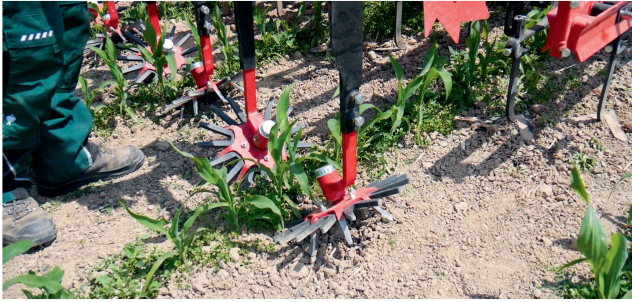
Les dents de sarclage peuvent travailler à proximité des rangs ou dans l'interligne.
