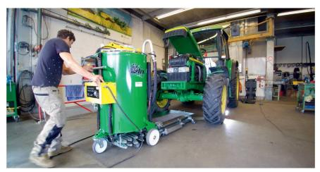
Une fois alimenté en air comprimé, l'«Ölix» est placé face au tracteur et le bac est poussé sous le véhicule par le bras extensible dont on distingue les articulations repliées sous le réservoir vertical. Photos: Roman Engeler
