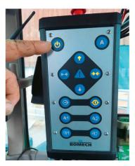
Au moyen de la commande «i-Control» on peut activer l'épandeur avec le système load sensing ou par courant constant avec une vanne de commande à effet simple avec retour sans pression. La commutation se fait en un tour de main.
