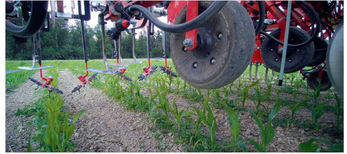
Cette machine est équipée d'éléments de sarclage dits «combi» fixés sur un support vibro.
