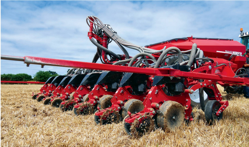
Équipée pour semer à grande vitesse, cette machine de type «Maestro CX» est munie de doseurs «AirSpeed». Photos : Roman Engeler
