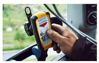
La gestion de l'appareil intervient via une télécommande; les commandes sont progressives, par paliers.
