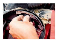
Le sélecteur des deux systèmes est simplement inséré dans le boîtier. Il ne nécessite plus de réglage.
