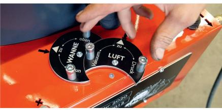
Vannes-robinets sur le pupitre de commande pour choisir entre aspiration et refoulement et pour sélectionner le point d'aspiration.
