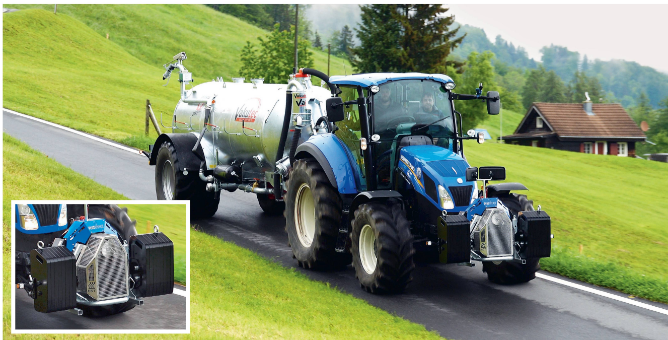
Avec le «PlusBremse», les freins de service ne surchauffent pas dans les longues descentes et gardent leur efficacité. Photos : Ruedi Burkhalter
