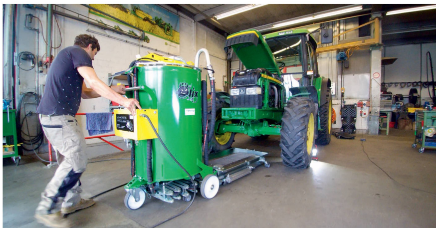
Une fois alimenté en air comprimé, l'« Ölix » est placé face au tracteur et le bac est poussé sous le véhicule par le bras extensible dont on distingue les articulations repliées sous le réservoir vertical. Photos: Roman Engeler
