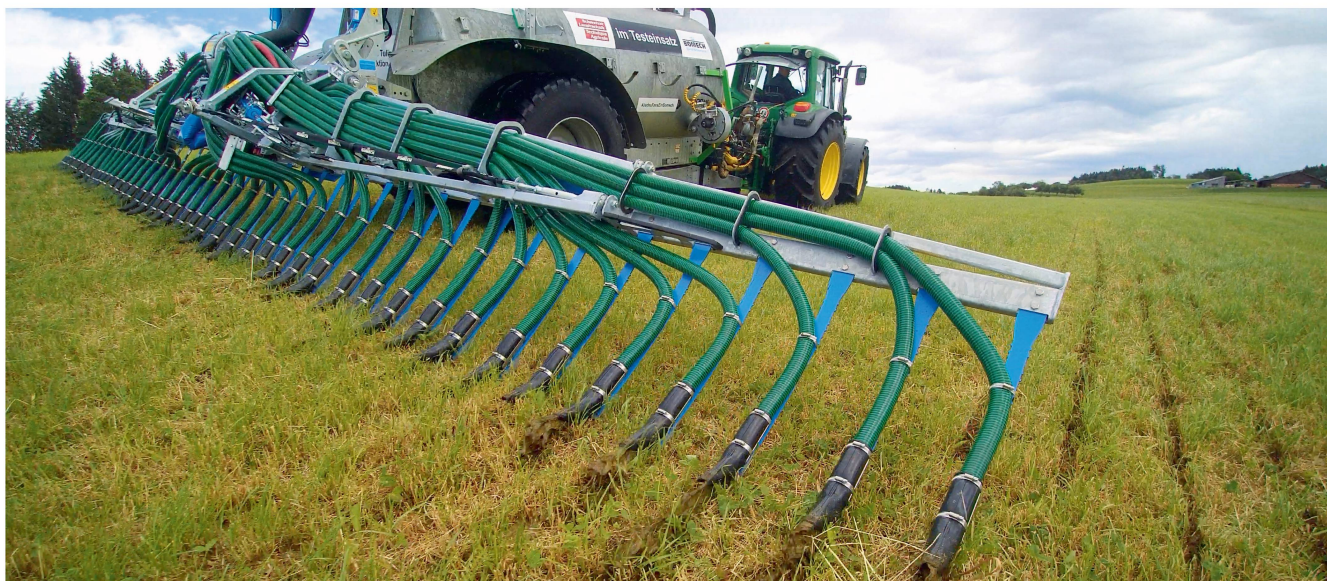
D'une largeur de travail de 10,5 mètres, le « Speedy One » de Bomech intègre des technologies appliquées à la pratique. Il résiste aux intempéries et ses émissions sont réduites. Photos: Martin Abderhalden et Roman Engeler
