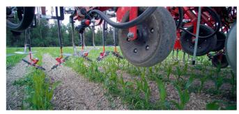
Cette machine est équipée d'éléments de sarclage dits « combi » fixés sur un support vibro.
