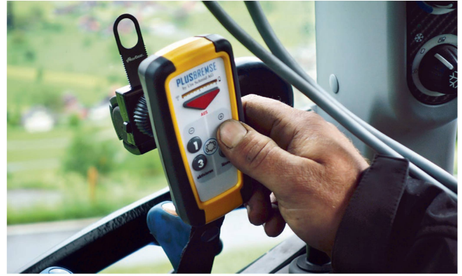
La gestion de l'appareil intervient via une télécommande; les commandes sont progressives, par paliers.
