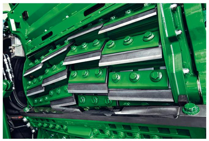
John Deere a choisi d'aiguiser les couteaux en douceur en faisant tourner le tambour à l'envers. Photo: John Deere
