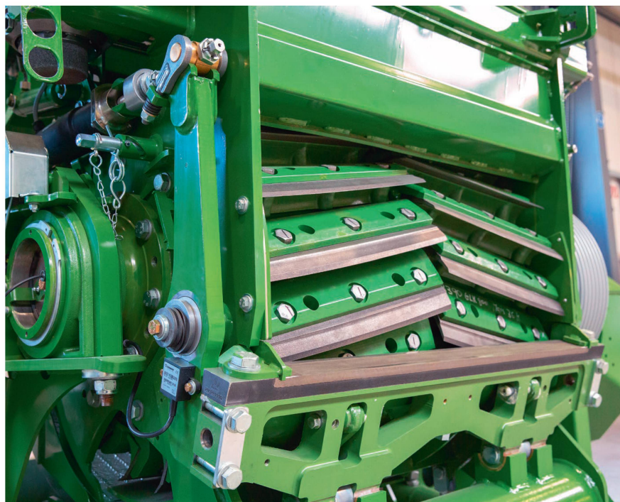
La disposition des couteaux en V sur le tambour de hachage est actuellement la plus fréquente.
