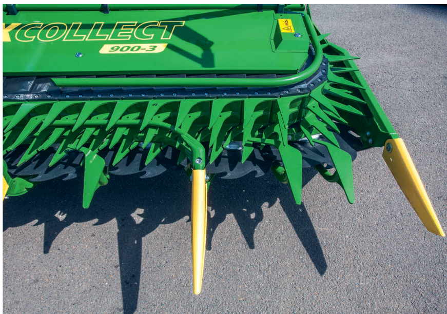
Le dispositif de récolte du maïs quelque peu singulier de Krone contient un collecteur à chaîne. Photo: Krone
