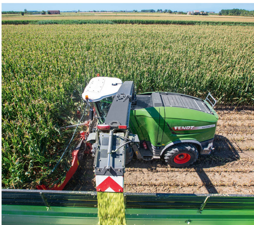
La vitesse d'avancement s'adapte automatiquement à la densité de récolte grâce à un régulateur de charge. Photo: Fendt
