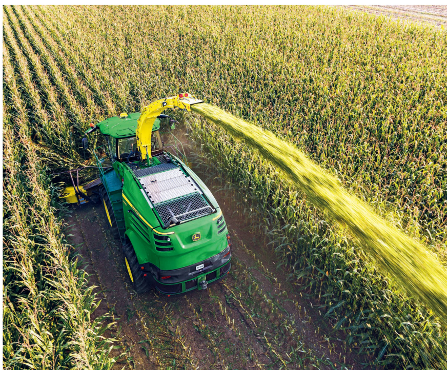
La distance de projection résulte du réglage de la puissance de l'accélérateur Photo: John Deere
