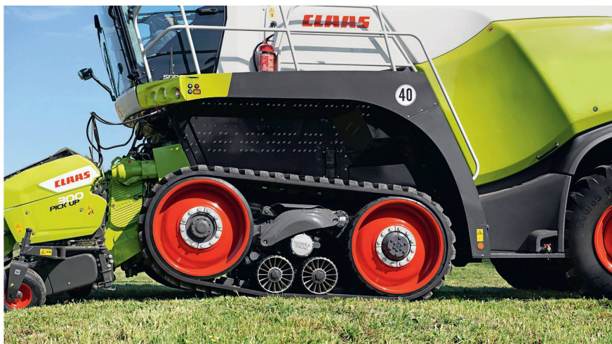
Lors des manœuvres, les roulettes centrales des chenilles «TerraTrac» sont pressées hydrauliquement vers le bas. Photo: Claas
