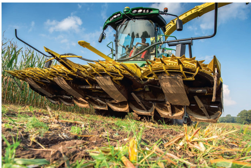
Avec le « StalkBuster » de Kemper, on vise à concasser autant que possible les chaumes de maïs. Photo: John Deere
