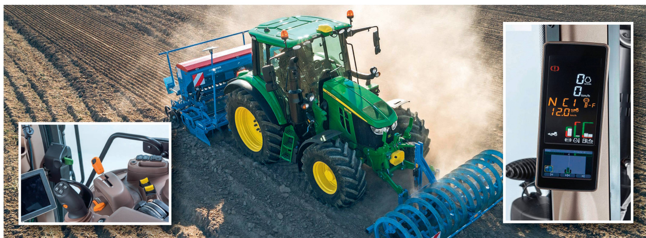
La gamme «6M» a été dernièrement équipée de la transmission à variation continue «AutoPowr». L'«AutoTrac» peut dorénavant s'afficher aussi sur l'écran du moniteur d'angle de la cabine. Photos: ldd
