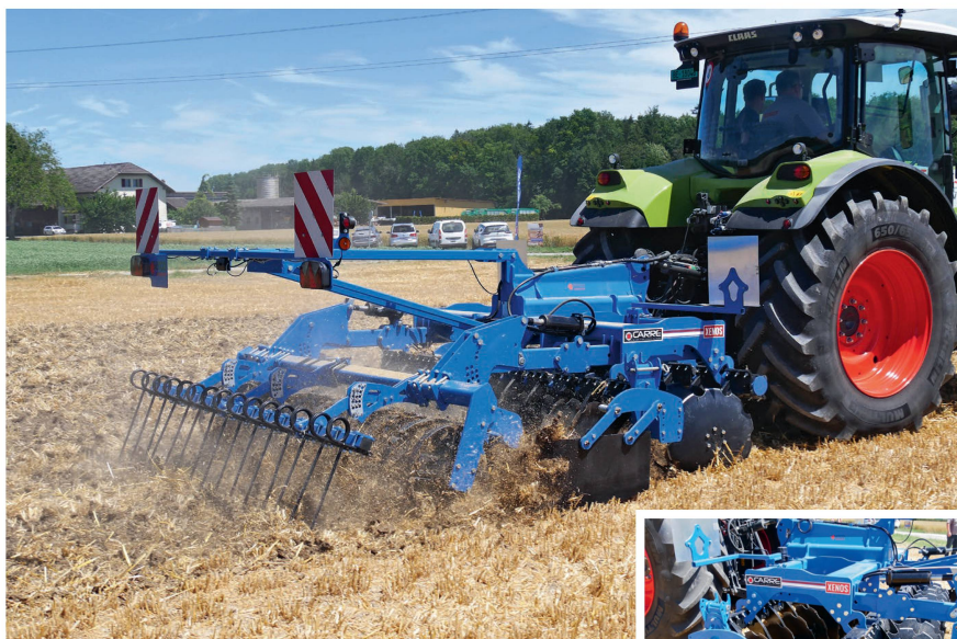
La déchaumeuse courte « Xenos » comprend 22 disques creux crénelés pour une largeur de travail de 3 mètres. Elle est utilisée ici avec un rouleau à lames souples et une herse-peigne à 1 rangée.
