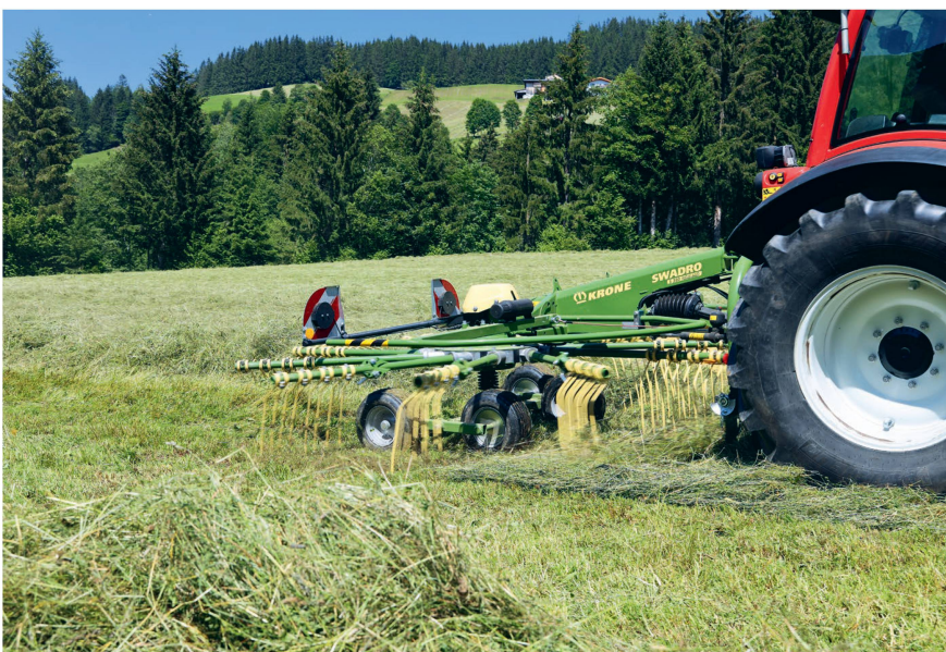
Les andaineurs conçus pour la montagne reprennent des éléments des « Swadro » classiques, tout en étant plus légers et de construction plus basse.
