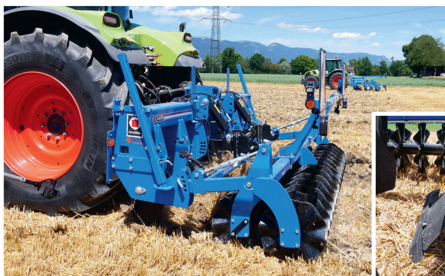
L'ameublisseur « Neolab Eco » est équipé de six lames brevet « Michel 800 » et d'un système de relevage de catégorie 3. Une plaque d'usure placée en amont de la lame permet de soulever légèrement le sol.
