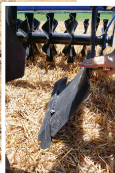
L'ameublisseur « Neolab Eco » est équipé de six lames brevet « Michel 800 » et d'un système de relevage de catégorie 3. Une plaque d'usure placée en amont de la lame permet de soulever légèrement le sol.
