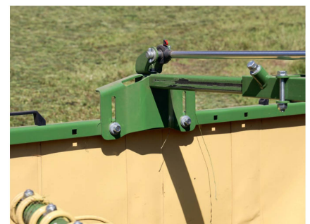
On peut prendre l'option de repliement et de réglage hydraulique de la toile d'andainage.
