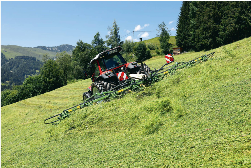
La nouvelle gamme « Vendro » englobe des faneuses rotatives à quatre, six et huit toupies.
