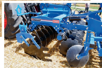
La déchaumeuse courte « Xenos » comprend 22 disques creux crénelés pour une largeur de travail de 3 mètres. Elle est utilisée ici avec un rouleau à lames souples et une herse-peigne à 1 rangée.
