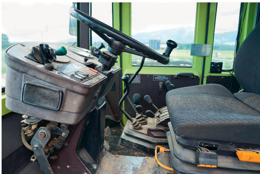
Le poste de conduite est dépouillé mais fonctionnel. Il faut du doigté et de la patience pour passer les vitesses avec le levier en double H.
